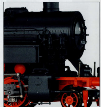
Le poids de la boîte à fumée repose sur un support ajouré.
