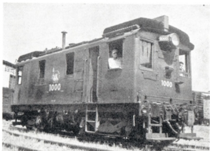
Première locomotive diesel électrique américaine du Jersey Central, construite en 1925 - puissance 300 CV.
