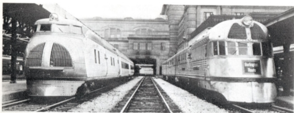
A gauche, autorail « City of Salina » de l'Union Pacific, à moteur à pétrole lampant. — A droite, premier autorail diesel du Burlington (1934). (Photo General Motors.)
