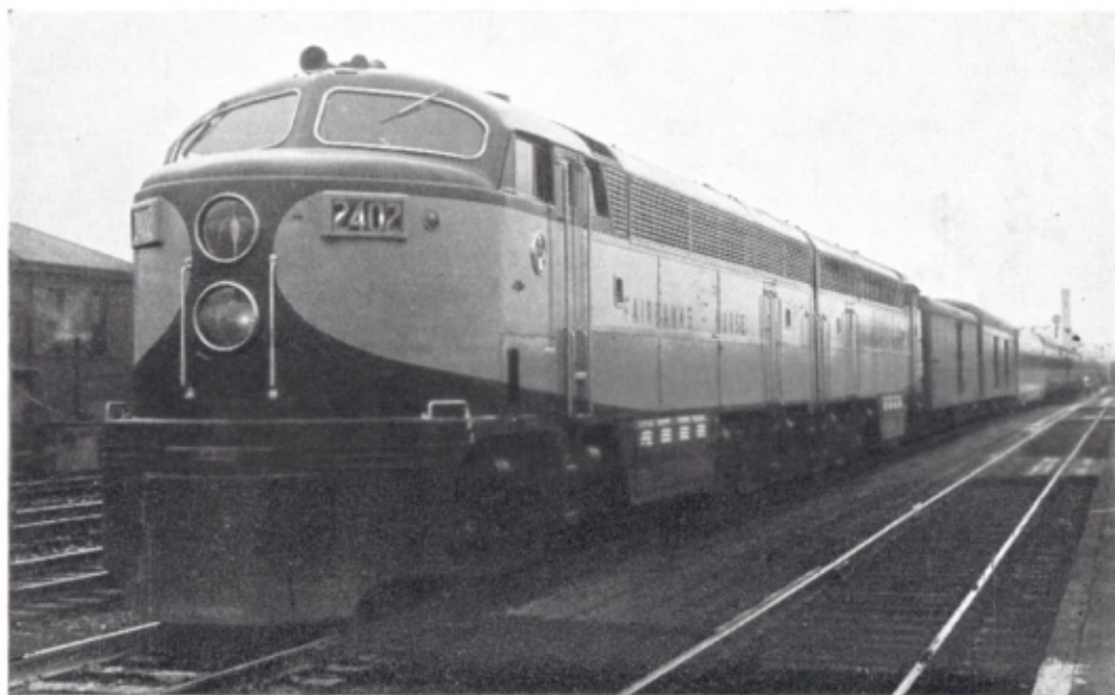
Locomotive diesel-électrique type C de 4.800 CV. en essai entre Chicago et Milwaukee.
