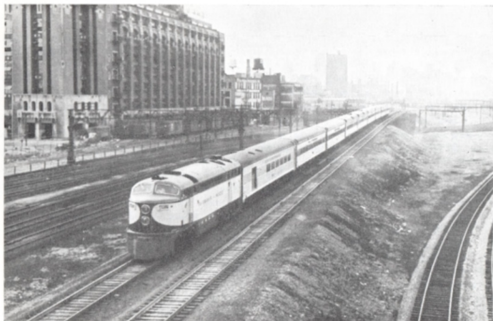
Locomotive de démonstration Fairbanks-Morse de 2.400 CV. arrivant à Chicago en tête du train de luxe « James Whitcombe Riley » du New York Central Rr (Cincinnati-Indianapolis-Chicago.) (Photo Fairbanks-Morse.)
