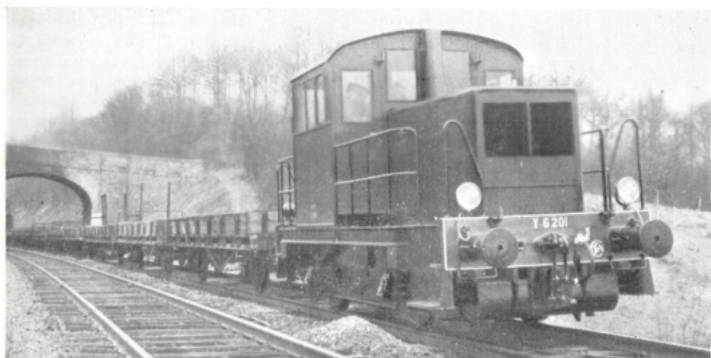
Locotracteur unifié de 150 CV, de la S.N.C.F. pour la desserte des lignes secondaires et d'embranchement. (Photo S.N.C.F.)
