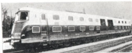
Locomotive diesel-électrique de 4 x 1.050 CV. de la S.N.C.F. - 2C2 + 2C2 - 130 km./h. (Photo S.N.C.F.)
