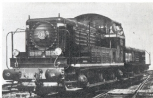
Locomotive diesel-électrique 030 DA de la S.N.C.F. - année 1950 - 510 CV. - 60 km/h. (Photo S.N.C.F.)
