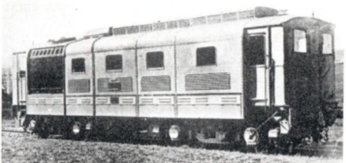
Locomotive diesel-électrique des C.F.A. - BB - 1935 - 750 CV. - 95 km./h. (Photo C.F.A.)
