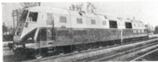
Locomotive diesel-électrique de 2 x 2.200 CV. de la S.N.C.F. 2C2 + 2C2 - 130 km./h. (Photo S.N.C.F.)
