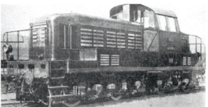
Locomotive diesel-électrique de la S.N.C.F. - BB - 1938 - 550 CV. - 50 km./h. (Photo S.N.C.F.)
