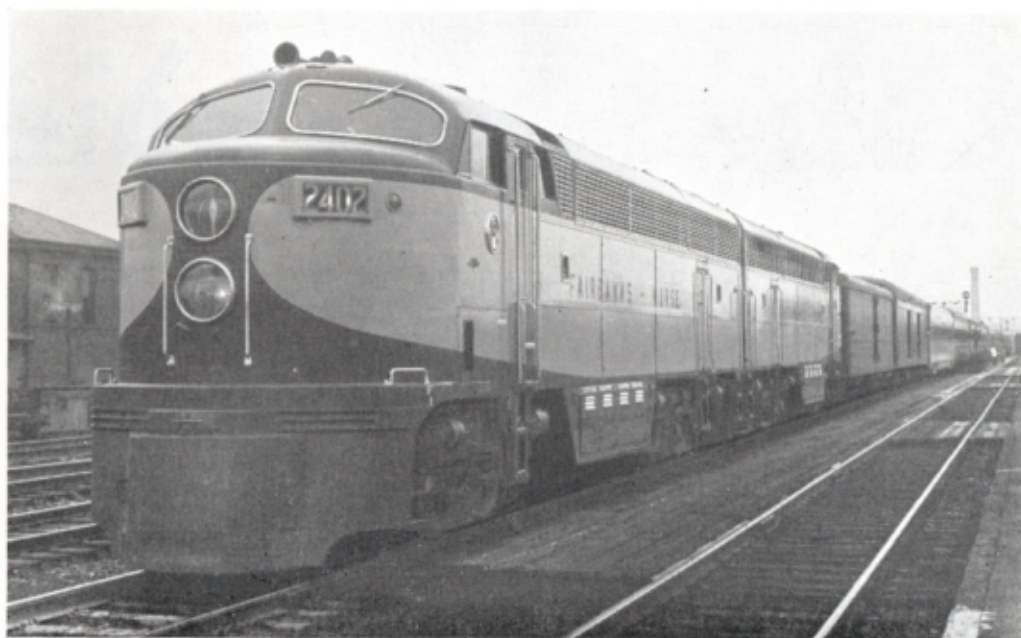
Locomotive diesel-électrique type C de Fairbanks-Morse - 4.800 CV, en essai entre Chicago et Milwaukee. (Photo Fairbanks-Morse.)
