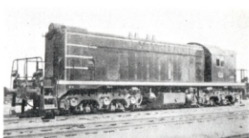
Locomotive diesel-électrique 040 DA de la S.N.C.F. - années 1946-49 - 660 CV. - 95 km/h. (Photo S.N.C.F.)
