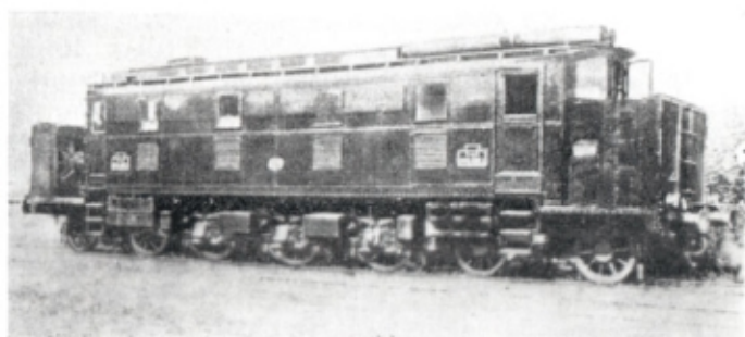
Locomotive diesel-électrique des C.F.A. - 2C2 - 1933 - 1200 CV. - 115 km./h. (Photo C.F.A.)
