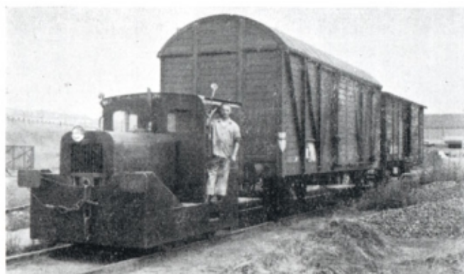
Locomotive diesel Moes de 48 CV. pour desserte des raccords. (Photo Moes.)
