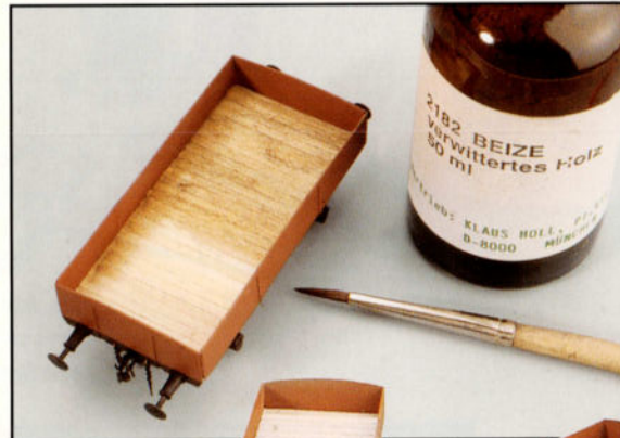
28 Le plancher du wagon est recouvert de fines languettes de bois de tilleul. Quelques coups de pinceau de peinture mate suffisent pour coller ces languettes au plancher. Après une journée entière, cette peinture est suffisamment sèche et les languettes peuvent alors être teintées au moyen de quelques traits de pinceau de brou de noix.
