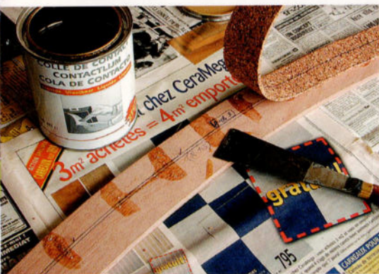
Figure 98: La fixation du liège sur la plate-forme peut s'effectuer à l'aide de colle contact, appliquée par plots et finalement écrasée sous la semelle.
