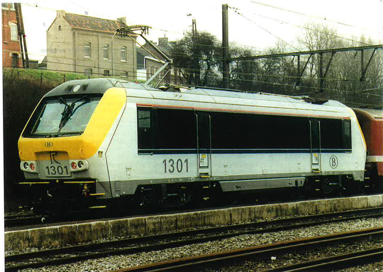
Op 19 februari staat loc 1301 tijdens de tests in Ronet te wachten aan het dienstperron voor een volgende "retourtrip" naar het einde van het emplacement. De locomotief wordt hier getest op een kort traject dat uitgerust is voor driefasige stroom. Locomotief 1901, die eveneens voor tractie met driefasestroom is uitgerust, rijdt mee om vergelijking tussen de beide locomotieven mogelijk te maken. Foto : Stefan Nicolai.
