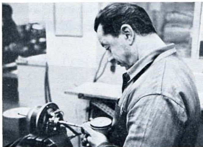
De heer Peetmans test de motor op een minuten-toerenteller.
