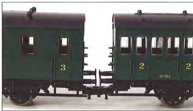
Als we de standaard beugelkoppelingen vervangen door de kortkoppeling van, in dit geval Fleischmann, ziet het resultaat er al heel wat beter uit. De buffers zijn een stuk dichter bij elkaar gekomen.
