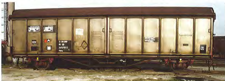
Wagen 01 88 247 2 705-3 gefotografeerd door Bart Luyten op 25 april 1994 in de Antwerpse haven, bundel Wilmarsdonk. Deze wagen heeft geen handrem. Foto Bart Luyten.
