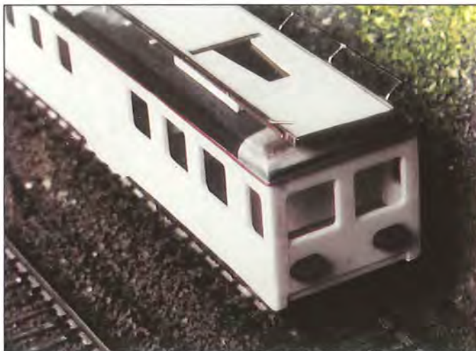
opname gemaakt tijdens de bouw. Ook hier zie je de uitsparing in het dak voor de uitklapbare test-pantograaf
