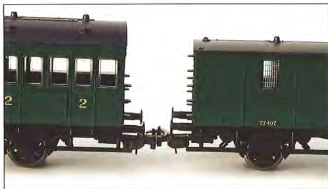
Met de standaard beugelkoppeling van Piko staan de buffers vrij ver van elkaar. Dit kan alvast beter.
