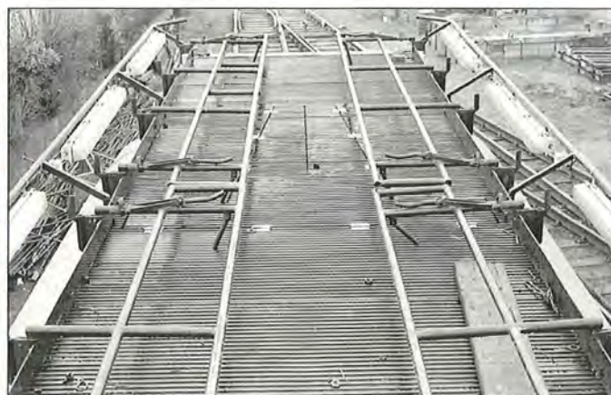
(zw/w) detailopname van het echte werkplatform, bemerk de opening voor de pantograaf
