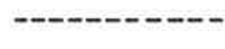
Circuit pour mémoire. (2 traits par 5mm. environ). Herinnering van stroomkring (2 lijnen per 5mm ongeveer).
