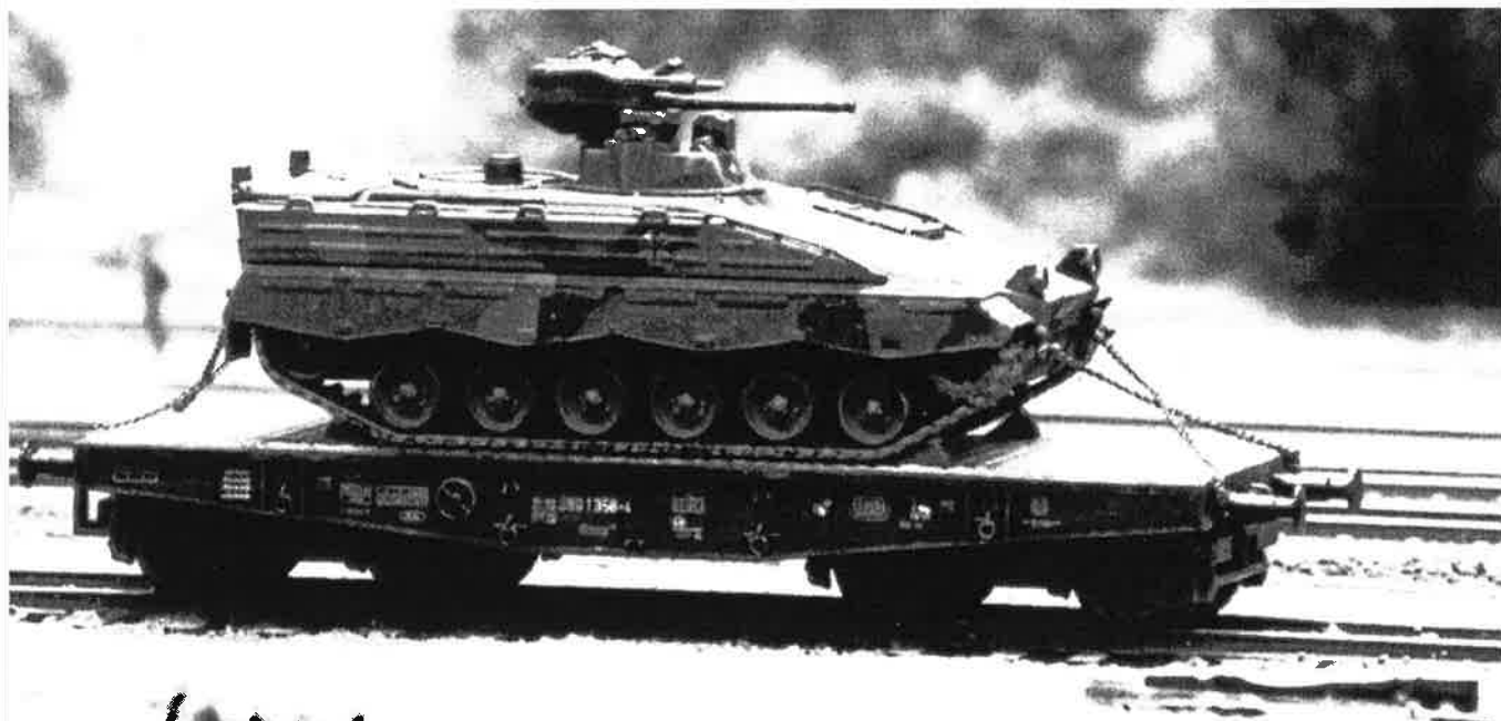
Plat à bogies Slmmp de la DB chargé d'un char. Peinture «camouflage» sur le char, patine wagon. Galage et chaînes d'arimage, présenté par Christian Auquière.
