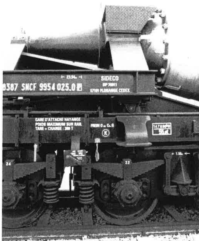
Détails de la superbe torpille SNCF en stationnement devant l'atelier d'entretien des wagons de Monceau. Visite pour Usinor d'un wagon spécialisé pour la sidérurgie.
