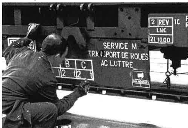
L'irremplaçable main humaine : le lettré retouche le marquage pour les faire correspondre aux travaux qui ont été effectués sur le wagon plat 40 88 958 4 962-3 : révisé par Monceau (LNC) le 21 octobre 2000.
