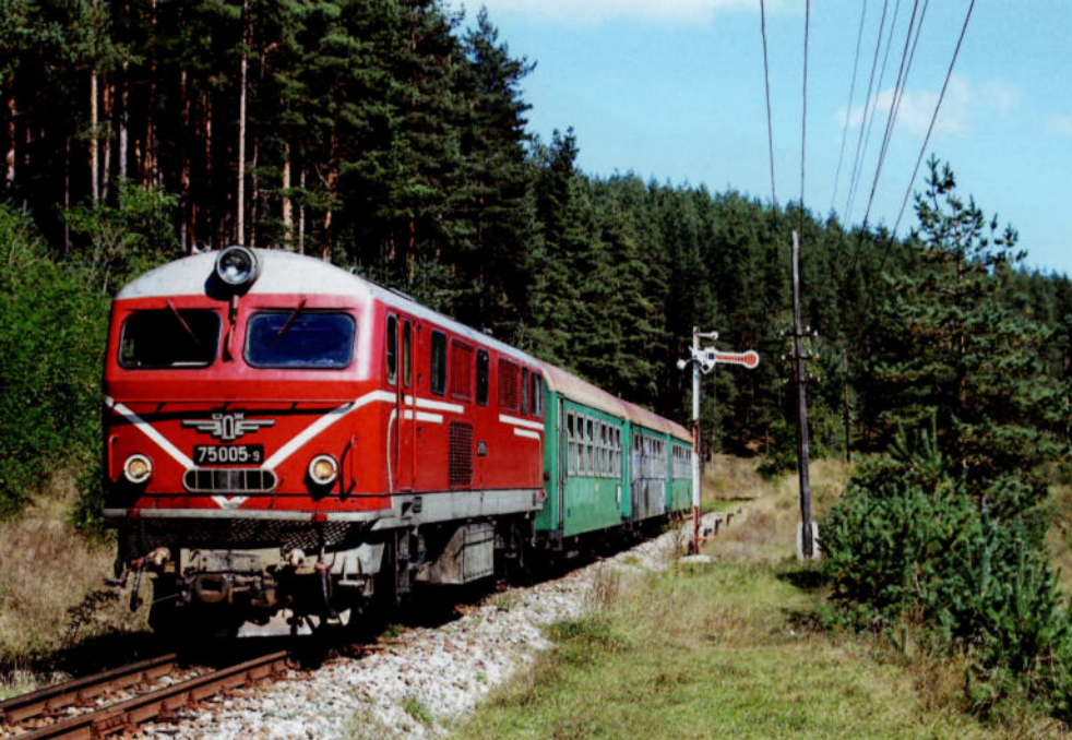
PHOTO 132-62 Certains croisements sont encore protégés par une signalisation mécanique, comme ici à Avramovo. Le 12 septembre 2015, un train vient de quitter cette gare et se dirige vers Dobrinishte, avec à sa tête la 75005. A droite se trouve le signal d'entrée de la gare. Lars LAENEN.
