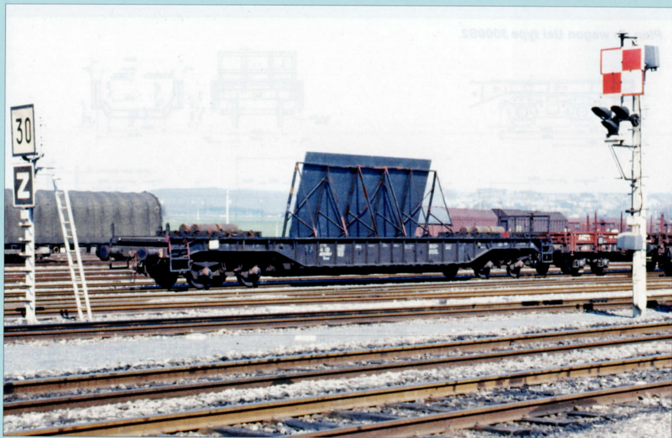
↑ Le wagon 21 88 465 0 002-1 (ex. 477.461) Type 3000B4 Sklmp, chargé d'une tôle hors gabarit. Givet, 21 avril 1984. Charles OCSINBERG.
