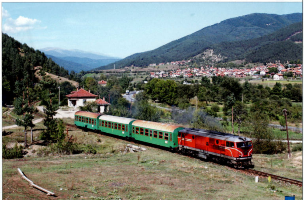
PHOTO 132-65 Le 15 septembre 2015, un train remorqué par la 77002 (FAUR 25326) quitte la gare de Dagonovo. Les locomotives des séries 75 et 77 sont équipées d'un moteur Diesel Maybach de 1100 CV et d'une transmission hydraulique. Leur masse s'élève à 48 t pour les 75, et 52 t pour les 77. La vitesse maximale est fixée à 70 km/h. Lars LAENEN.
