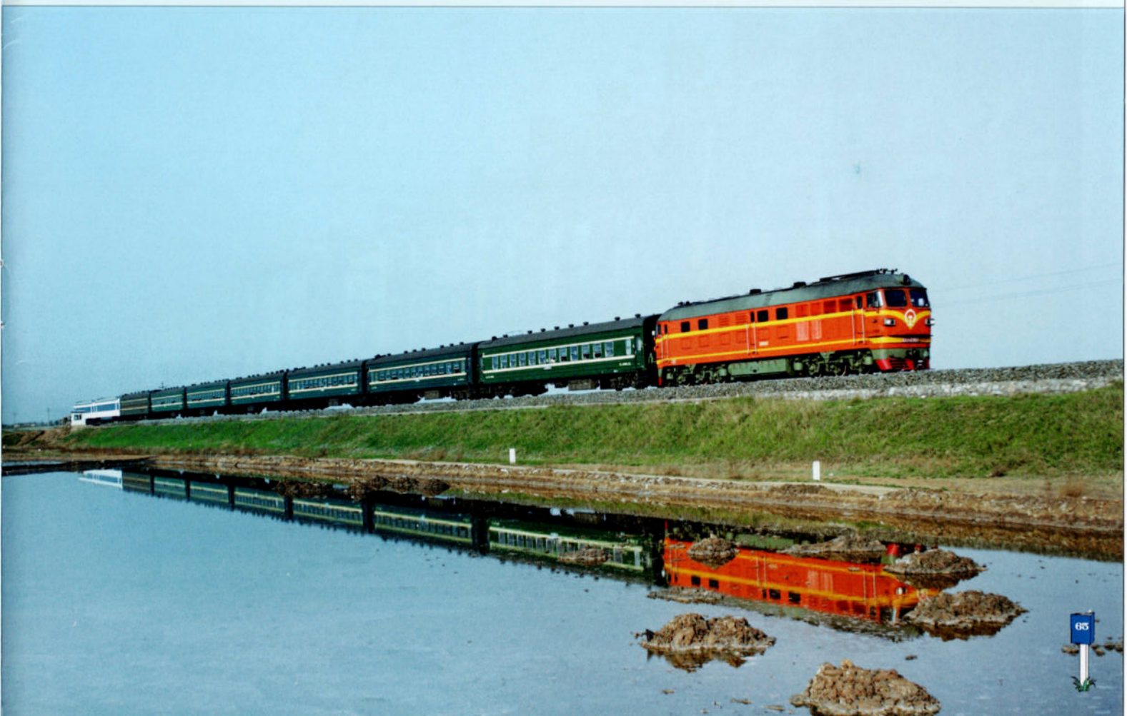
CHINE PHOTO 132-68 Le 23 avril 2006, un train de voyageurs remorqué par la DF4-2388 traverse des rizières dans les environs de Xiagui. Les DF4 sont les locomotives Diesel les plus courantes en Chine, construites depuis 1969 et produites en plusieurs variantes (DF4AZ, DF4B, DF4C, DF4D, DF4E etc.). D'une puissance de 2650 kW et pesant 138 t, les DF4 peuvent circuler à 120 km/h pour la version voyageurs et 100 km/h pour la version fret. Jean-Luc VANDERHAEGEN.
