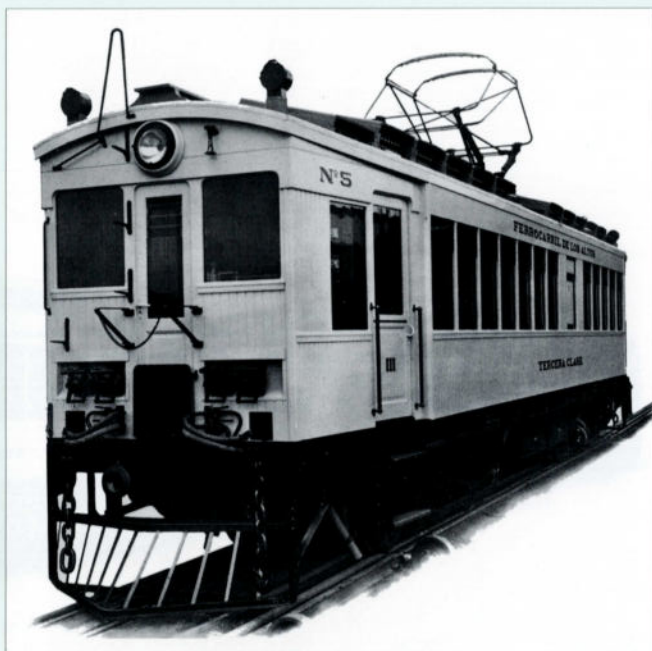
L'automotrice n° 5, pourvue d'un pantographe.
