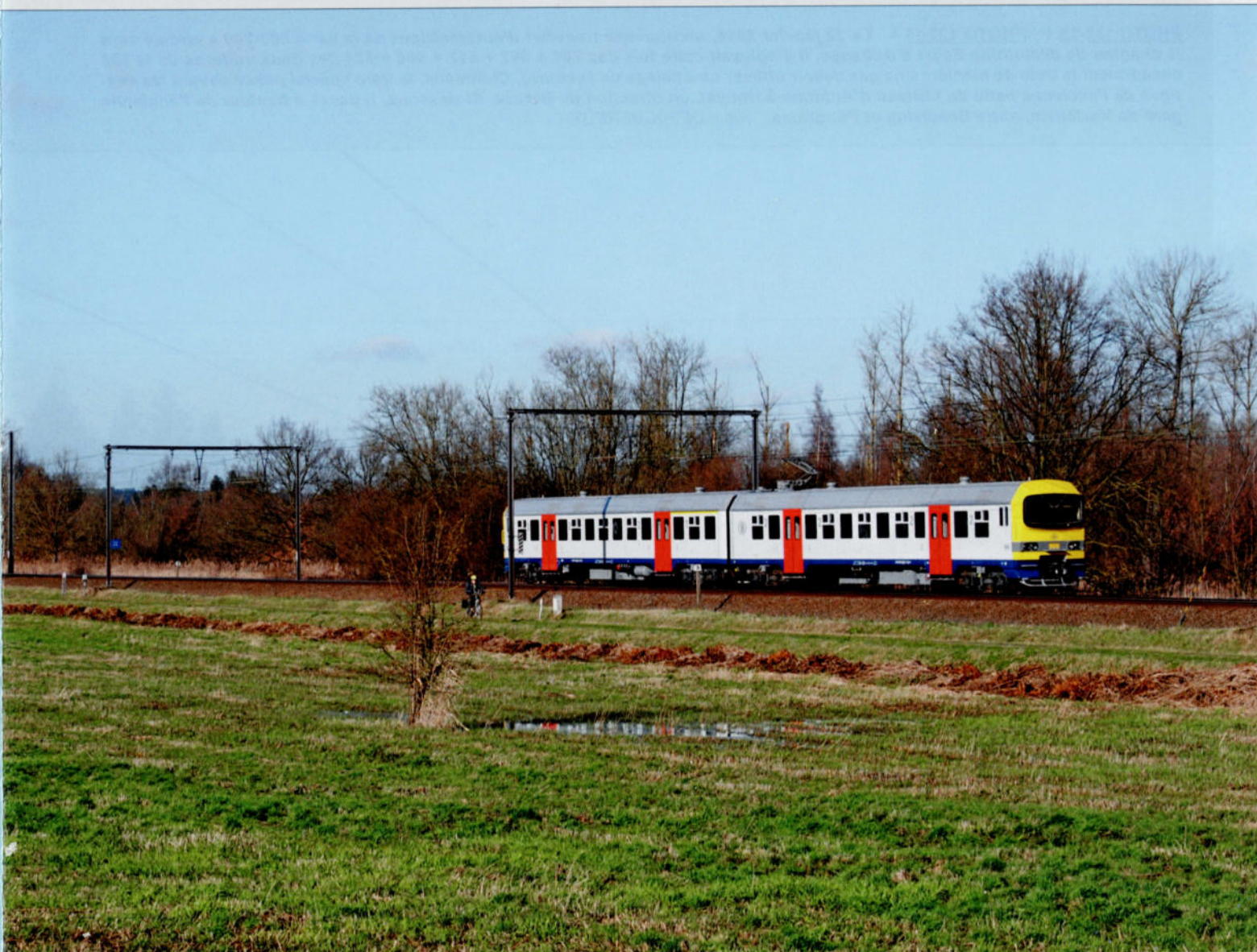
PHOTO 132-14 ↓ La modernisation des automotrices de la série 900 avance rapidement. Le 28 janvier, la 908 assurant son parcours d'essai est photographiée entre Testelt et Diest. Simon DE RIDDER.
