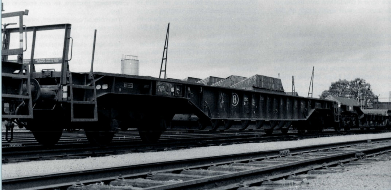
Le wagon 1.099.505 (ex. 377.477), futur type 3000S2. Nous voyons bien la structure du plancher évidé surbaissé. Photo SNCB.
