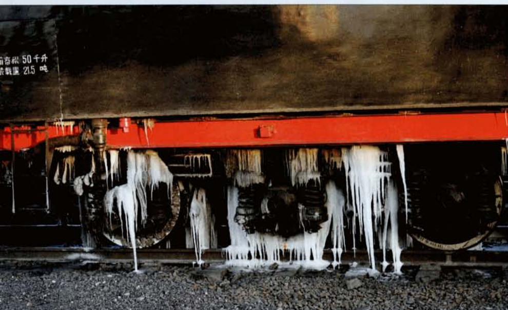
PHOTO 68-04 Le 29 décembre 2005, à JingPeng par -30^{\circ} , un bogie du tender de la QJ 6878 est entièrement pris par la glace durant de la prise d'eau... Par cette température, la glace est visible partout sur les locomotives : essieux, bielles, et même sur les bords du foyer et sur les déborbeurs ! Photo : PFT.
