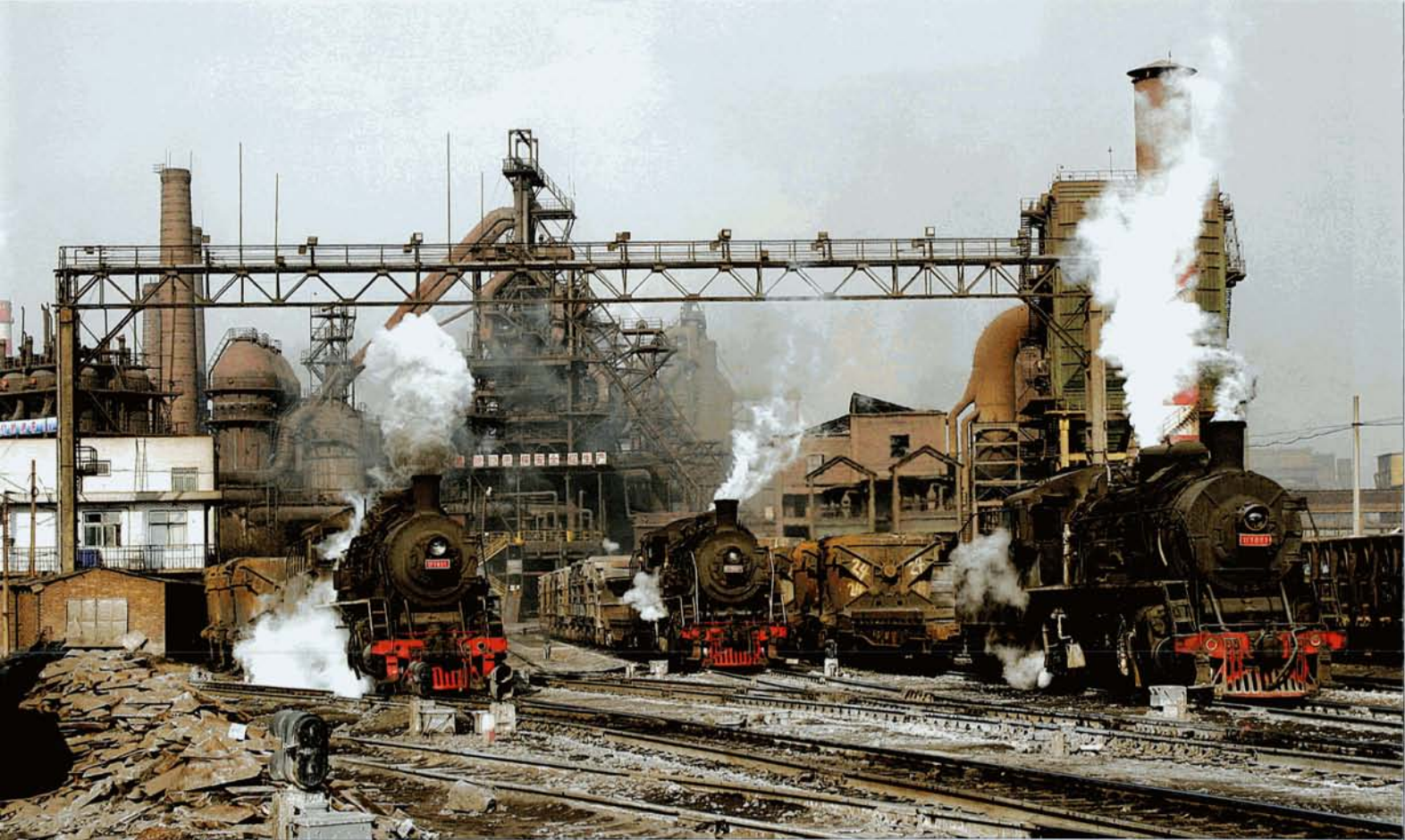
PHOTO 68-05 L'énorme complexe sidérurgique de Handan utilise toujours une vingtaine de locomotives à vapeur du type SY. Ici, les mouvements de trains se succèdent à un rythme soutenu, comme en témoigne cette photo où pas moins de trois rames de fonte et de laitier évoluent simultanément devant nos objectifs. Un spectacle irréal ! Photo PFT.
