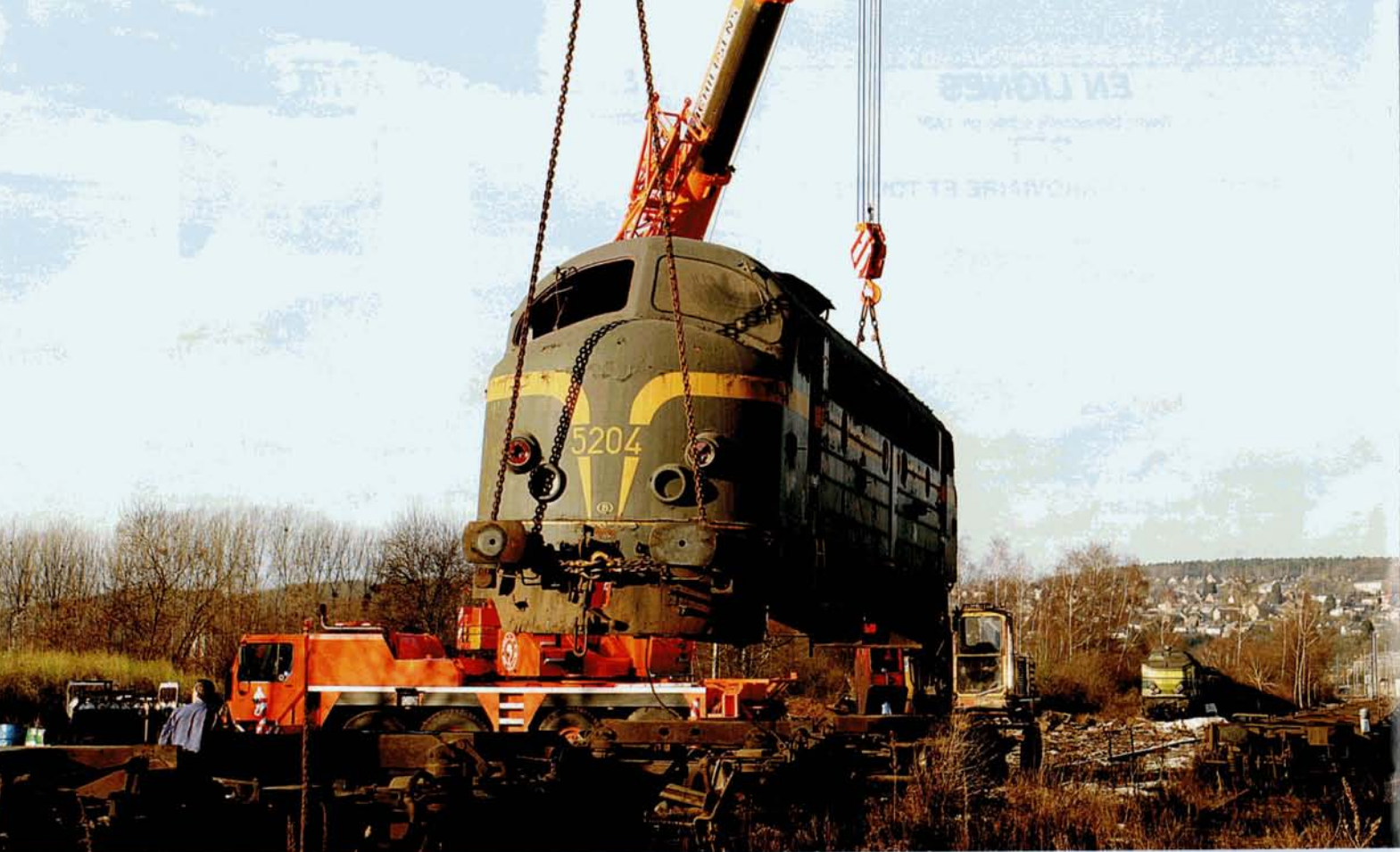
PHOTO 66-59 Le 4 janvier 2005, la 5204 fut levée à Ronet pour un échange de bogies avec la 5314.
