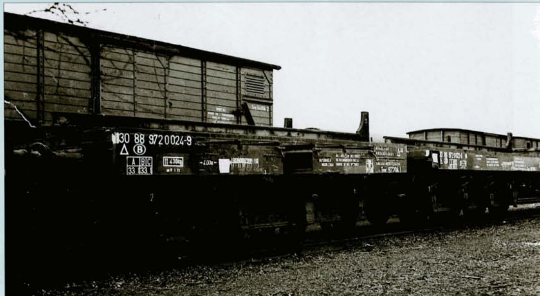
→ Les deux véhicules modifiés comme wagons-étalons (wagons de service type 9720A1 n° UIC 30 88 9720 024 et 025), photographiés à Leuven. Collection : Roger CRİKELAIRE.
