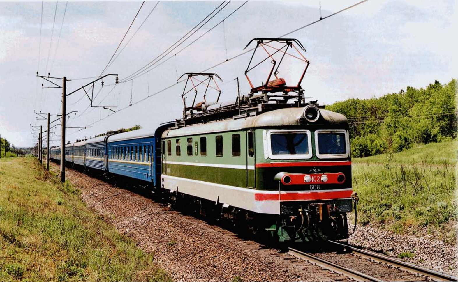
PHOTO 60-06 Le train PFT lors d'un arrêt-photo sur la ligne Dniepropetrovsk - Krasnoarmeisk. La ChS2-608 fait partie d'une série de 942 locomotives construites par Skoda de 1962 à 1973 (Co'Co', 3 kV =, 4200 kW, 125 t, 160 km/h). Krasnoarmeisk, 19 mai 2003. J-F HUART.
