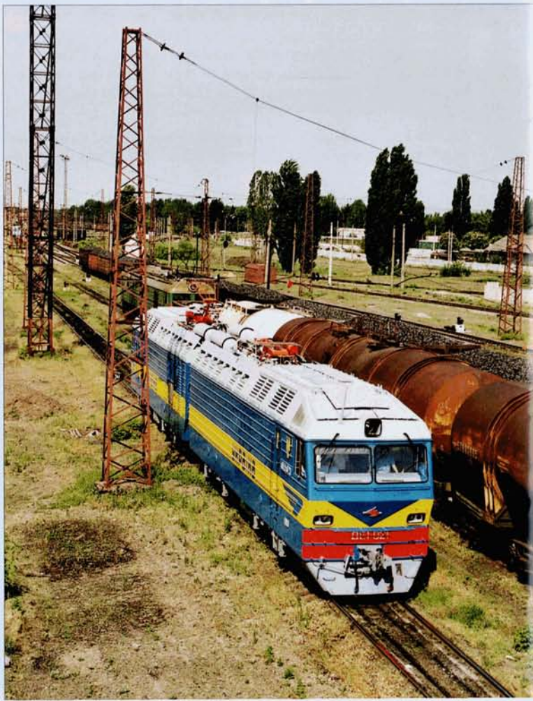
PHOTO 60-07 Une des 18 nouvelles machines doubles Bo'Bo' + Bo'Bo' de la série DE1 dans la gigantesque gare de triage de Uzel Severnych, le 19 mai 2003. Affectées au trafic marchandises, ces machines développent une puissance de 2 x 3125 kW. Leur masse totale s'élève à 2 x 92 t et leur vitesse maximale est limitée à 100 km/h. Alain DEFECHEREUX.
