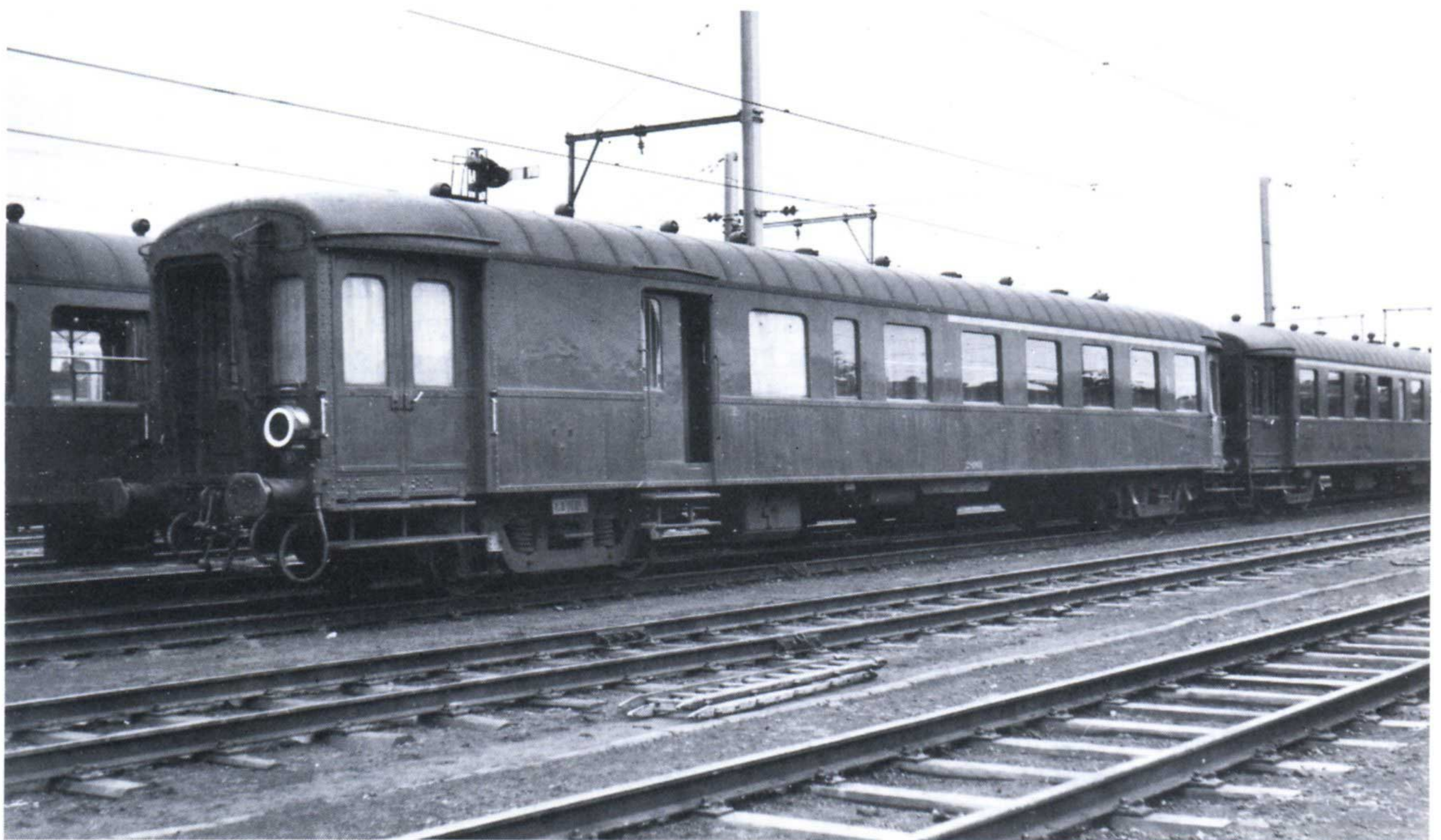
Quinze voitures K1-AB subirent une profonde transformation : un compartiment aménagé en snack-bar, trois autres compartiments supprimés et modifiés en fourgon. Ci-dessus la 28901, encore équipée de bogies Pennsylvania et avec fenêtres non modifiées. (Photo B. Dedoncker)
