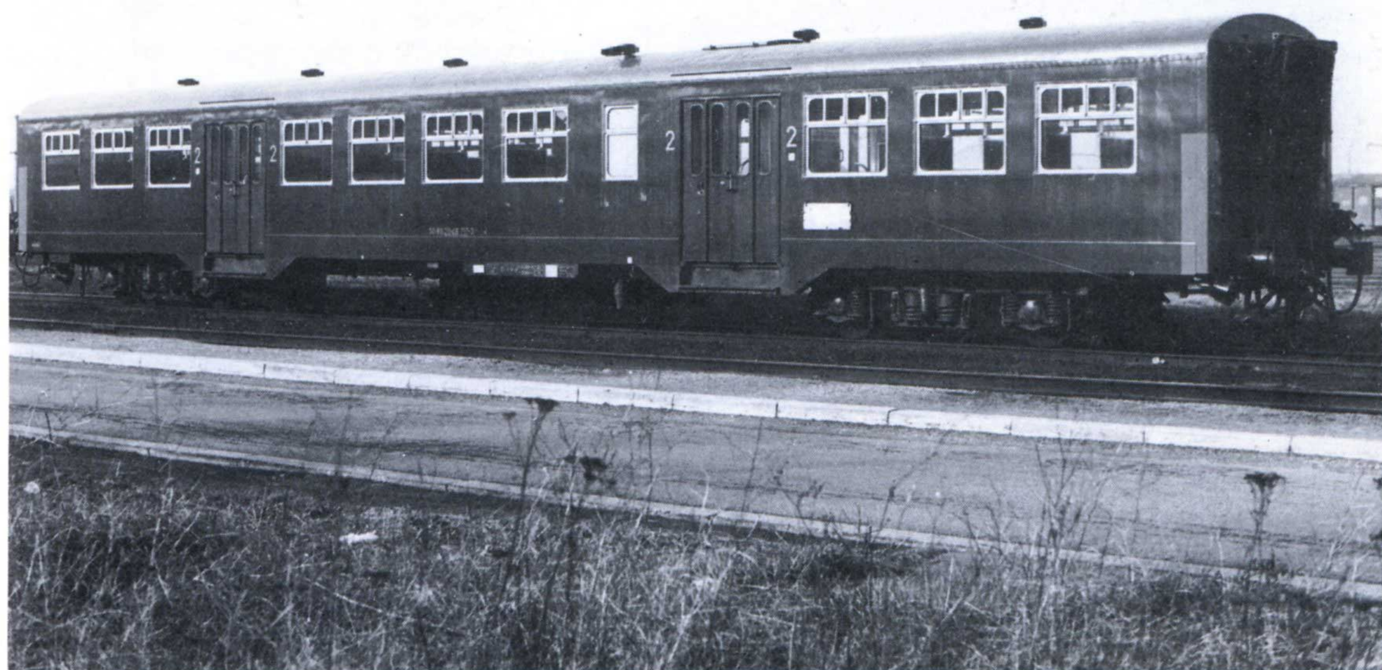
La voiture M2-B n° 42417 présente, aux quatre coins de la caisse, les bandeaux verticaux bleu pâle signifiant son aptitude à être incorporée dans des "rames réversibles électriques".
