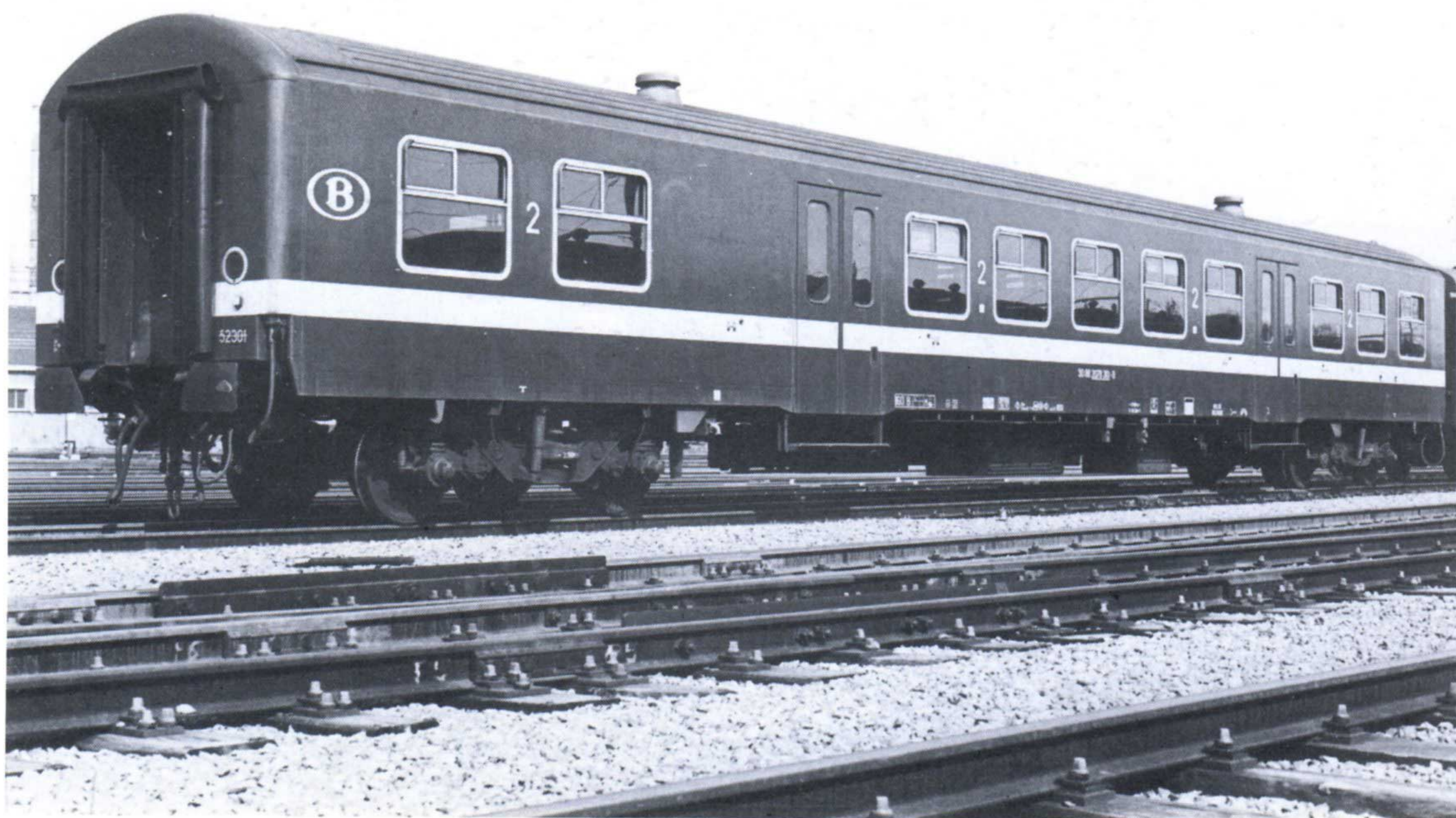
Les voitures M4 de deuxième classe constituent, à ce jour, la plus importante série de l'histoire du matériel métallique à voyageurs : 430 exemplaires, livrés de 1980 à 1984.
