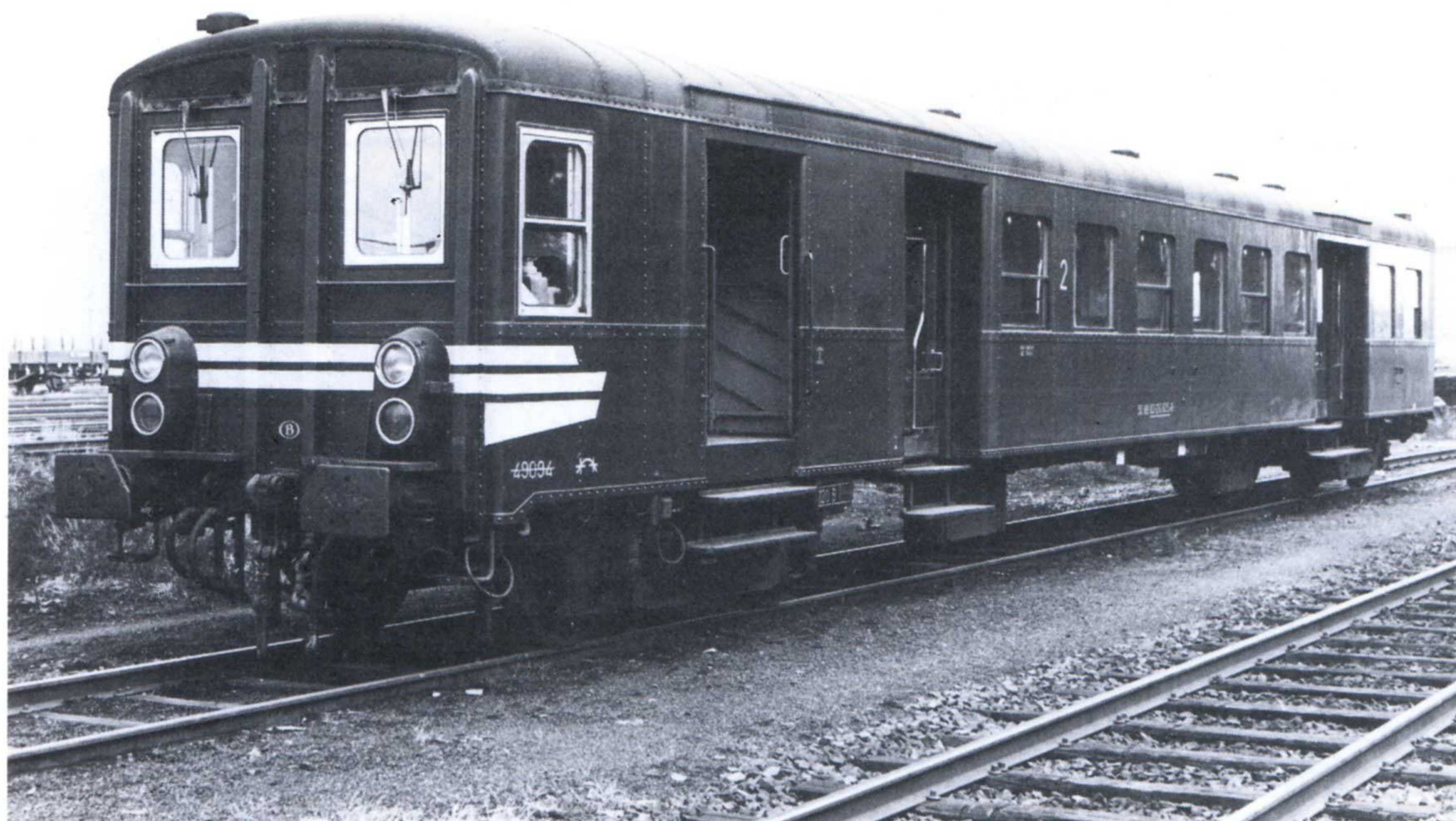
Il y a eu, en tout, 36 voitures M1-BD aménagées avec poste de conduite pour rames réversibles : 35 unités de 1966 à 1973, la 36ème - en remplacement d'une voiture avariée - au cours de l'année 1977.
