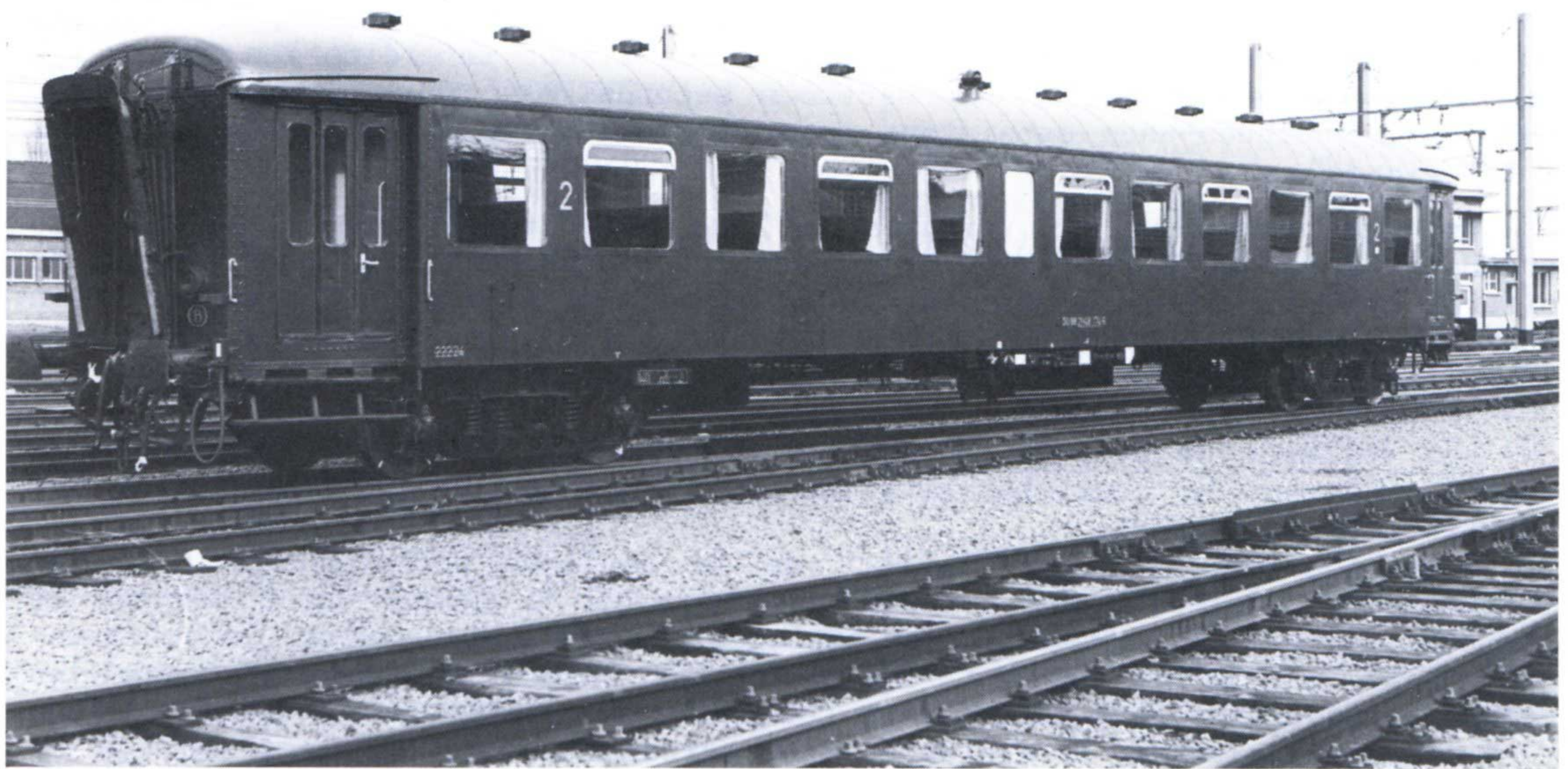
Voiture K2-B n° 22224, après remise en état (R3) à l'atelier central de Malines : le remplacement des vitres coulissantes par des châssis Widney a sensiblement modifié l'aspect extérieur du véhicule. Cent vingt-cinq de ces voitures ont été vendues aux chemins de fer du Maroc.
