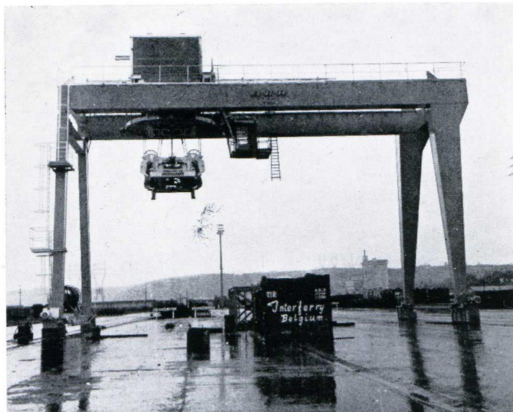
Ci-contre, à Bressoux, détail du grappin de la grue-portique pour la manipulations rapide et aisée des transcontainers.
