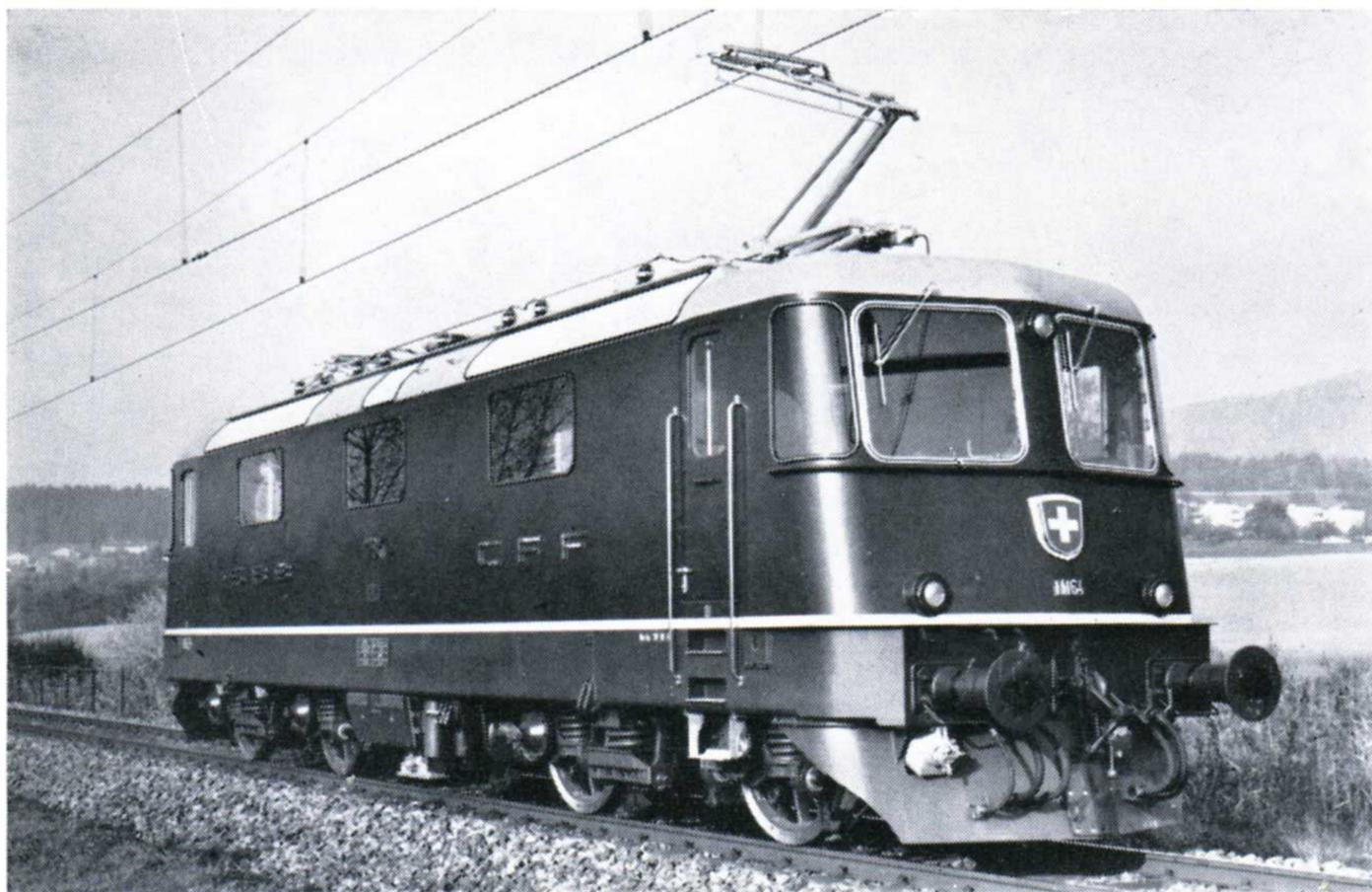
fig. 5 - locomotive Re 4/4II série 11156 à 11304 (photo C.F.F.)
