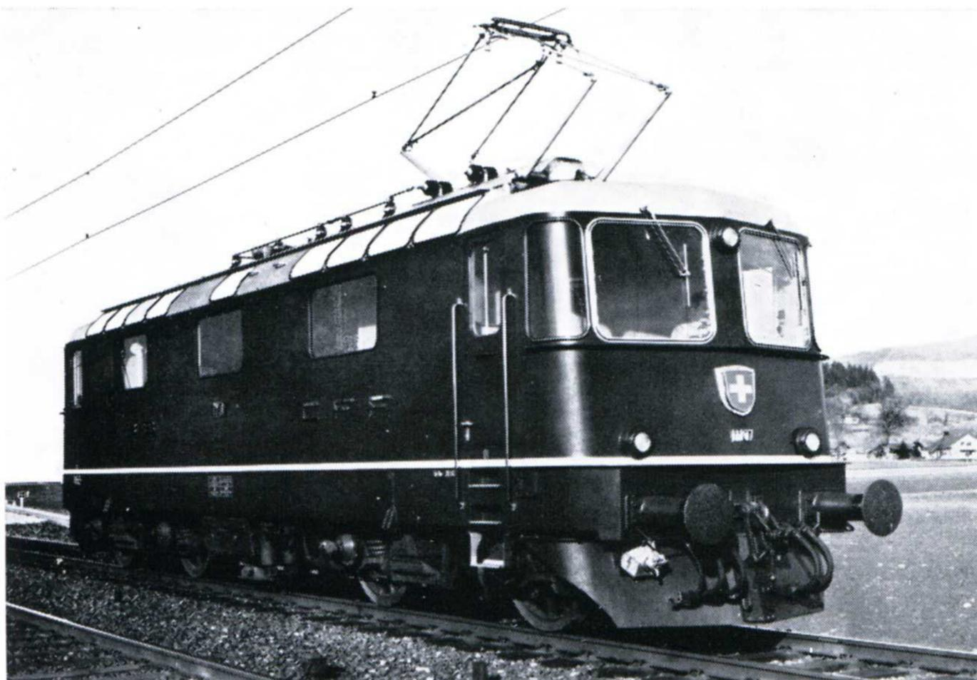
fig. 4 - locomotive pour service mixte Re 4/4 II - 11101 à 11155 de la série 11101 à 11254 ; construction de 1964 à 1973 - poids : 80 T - vitesse maximale : 140 km/h - puissance 6320 ch (photo C.F.F.)
