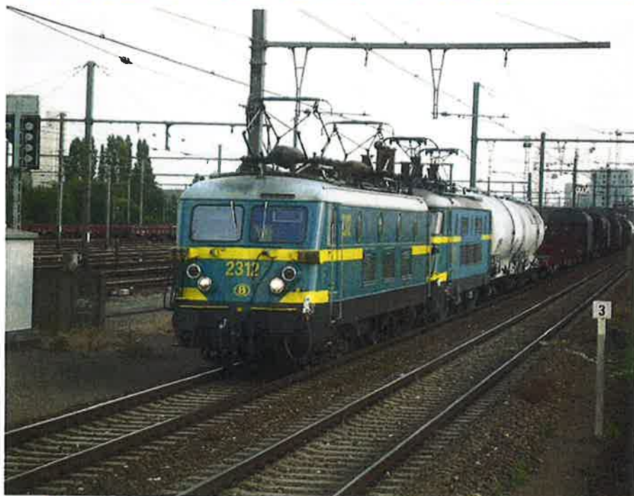
Op 30 juli 2010 trekken de 2312 en 2618 een bonte goederentrein richting Antwerpen Noord over lijn 35 te Leuven. Door gebruikmaking van de treinschakeling loopt de aanzetkracht op tot boven de 400 kN. Genoeg trekkraft om binnen de voorziene rijpaden te blijven. Foto: Erik Heylen.
