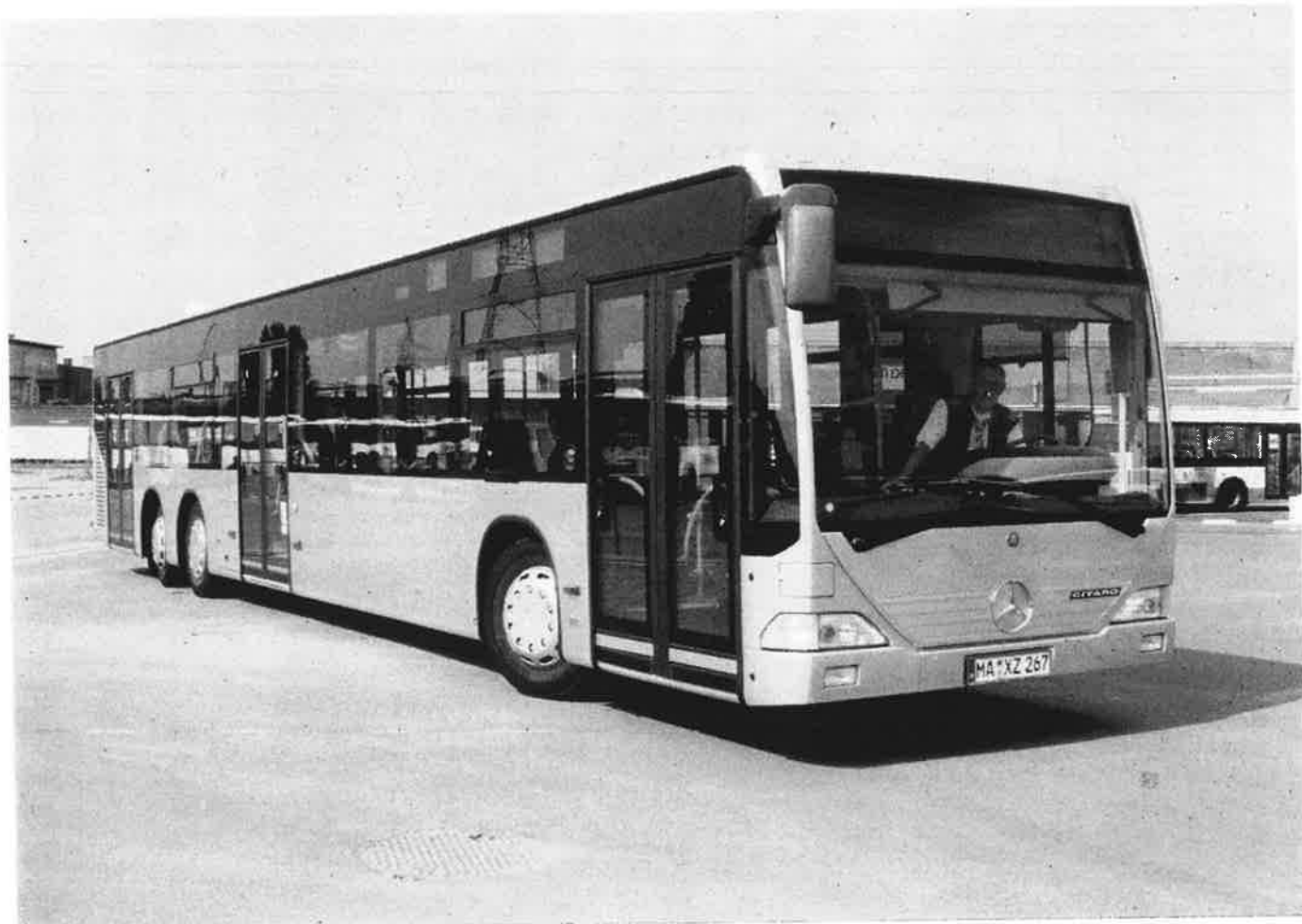
In 2003 testte De Lijn Antwerpen een drieassige Mercedes Citaro. Niettegenstaande de stuurbare achteras was de wendbaarheid in smallere straten toch wel eens een probleem. Tjalkstraat 26 augustus 2003 foto: William De Cock
