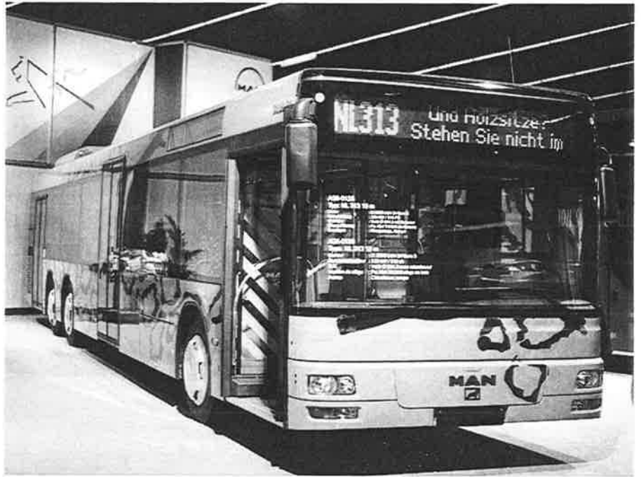
Foto boven : Op de stand van MAN stond een type NL313. Dit is een driedeursbus met een lengte van 15m en drie assen.
