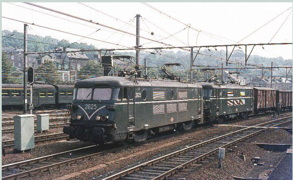
FOTO 111-11 Doorrit van een goederentrein gesleept door de 2625 en 2627 in het station van Namur. De 2625 werd kort daarvoor geschikt gemaakt voor het rijden in treinschakeling, wat valt af te leiden uit het groene vierkant rechts van de contactdoos. De aluminium band diende hiervoor onderbroken te worden. Julien CASIER, verzameling TSP.
