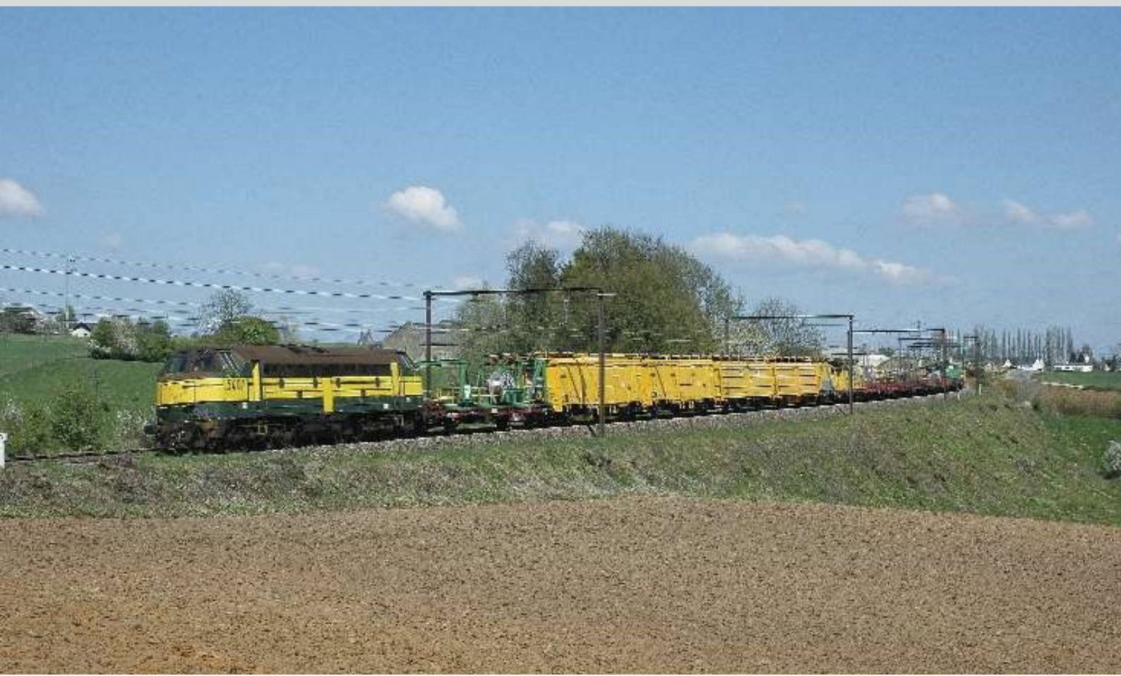
FOTO 92-20 De herelektrificatietreinen op het baanvak Autelbas-Sterpenich worden nog steeds gesleept door de reeksen 52, 53 en 54. De foto, genomen op 20 april 2009, toont de 5407 tussen Arlon en Autelbas terwijl zij de werktrein naar de werf sleept P. HERBIET.
