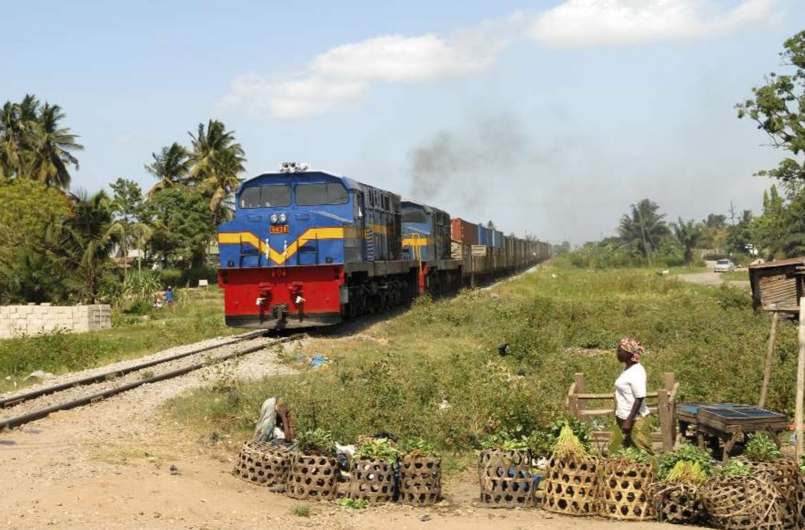
FOTO 92-xx Op 11 januari 2009 vertrekt een goederentrein, gesleept door twee locomotieven van de reeks 8800, uit Dar es Salaam. Van deze locs met asindeling 1Co'Co'1 werden 35 eenheden geproduceerd in 1972 en in 1979 door MLW in Canada. Vermogen 1880 pk, totale massa 103t, maximum snelheid 72km/h. Yves STEENEBRUGGEN.
