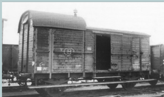
Pakwagen type 4020(1) nr. 13.467 maakt deel uit van de Duitse pakwagens van de reeks 13.000 t/m 13.700 verkregen door de Belgische Staat. Het onderstel van dit voertuigtype diende voor de bouw van de nieuwe pakwagens 13.601 t/m 13.603. Georges DESBARAX, verzameling Charles OCSINBERG.
