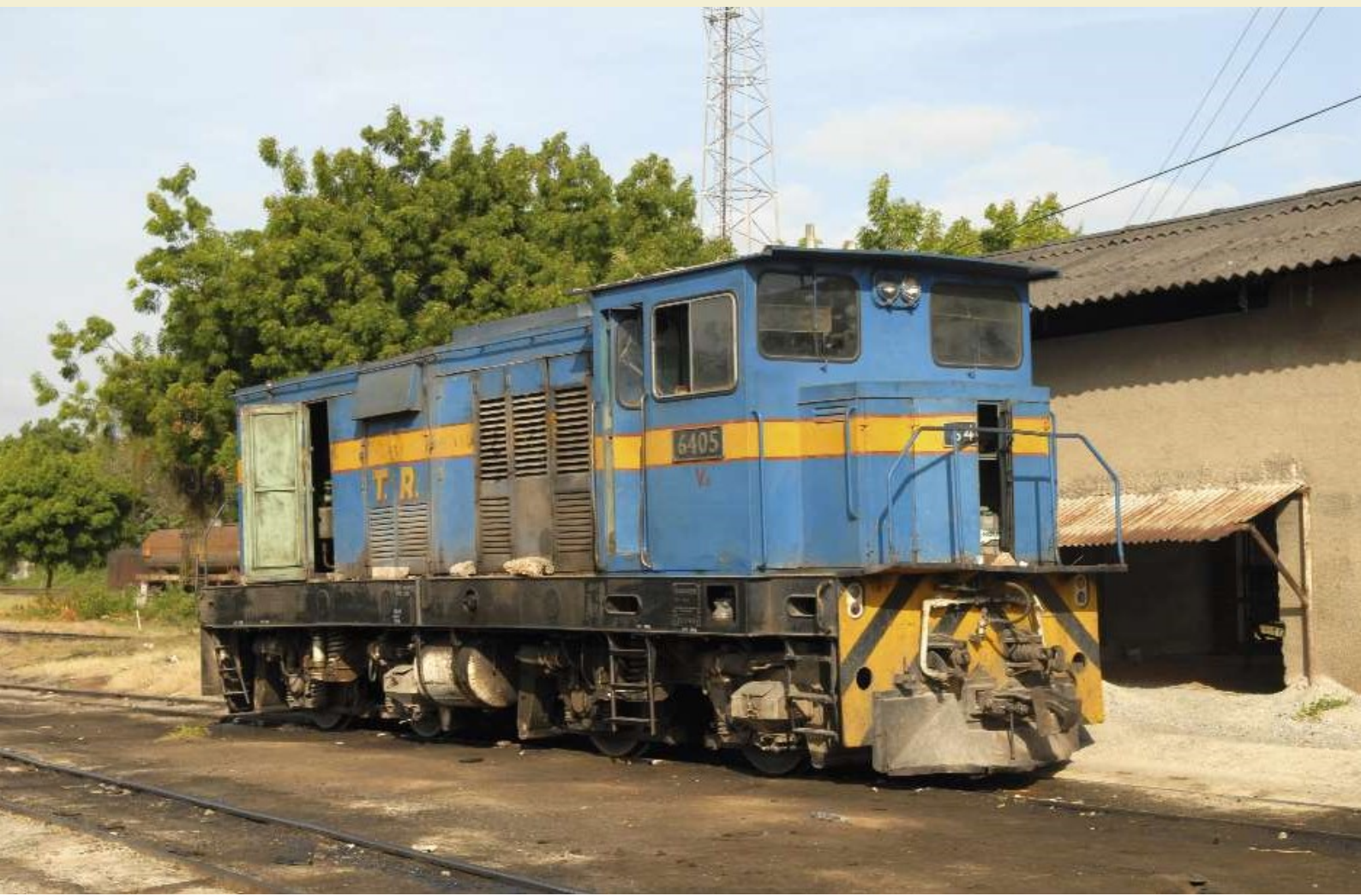
FOTO 92-xx Thyssen Henschel leverde in 1979 een reeks van 24 B'B' met hydraulische overbrenging. Zij vormden de reeks 6400 (vermogen 740 pk, totale massa 38,6t en een snelheid van 72 km/h). U ziet de 6405 in het depot van Dar es Salaam op 10 januari 2009. Thierry NICOLAS.
