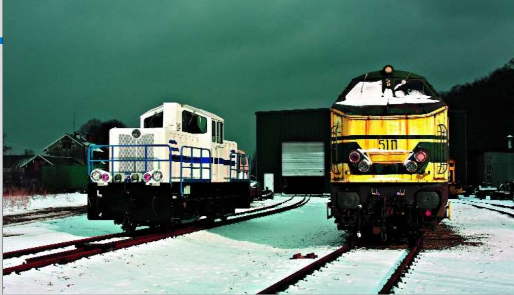
FOTO 90-40 Na een volledige revisie bij Rails & Traction te Raeren, wacht een diesellocomotief gebouwd door CFD en afkomstig uit de Speno-trein, op haar transport naar het smalspoornet van Corsica. Zij werd verbouwd van normaal- naar meterspoor. Rechts de 5111 die door het Italiaanse Esposito werd aangekocht.
