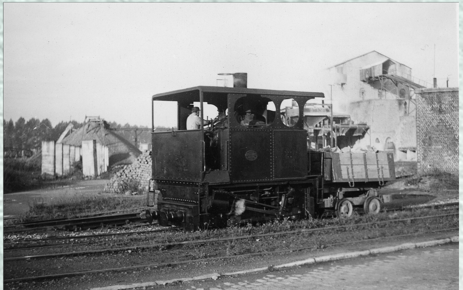
De kleine locomotief Cockerill nr. 3000 van 1921, type II voor meterspoor. Deze locomotief deed dienst bij de carrière Willocq in Lessines in 1947. G. Desbarax, verzameling.
