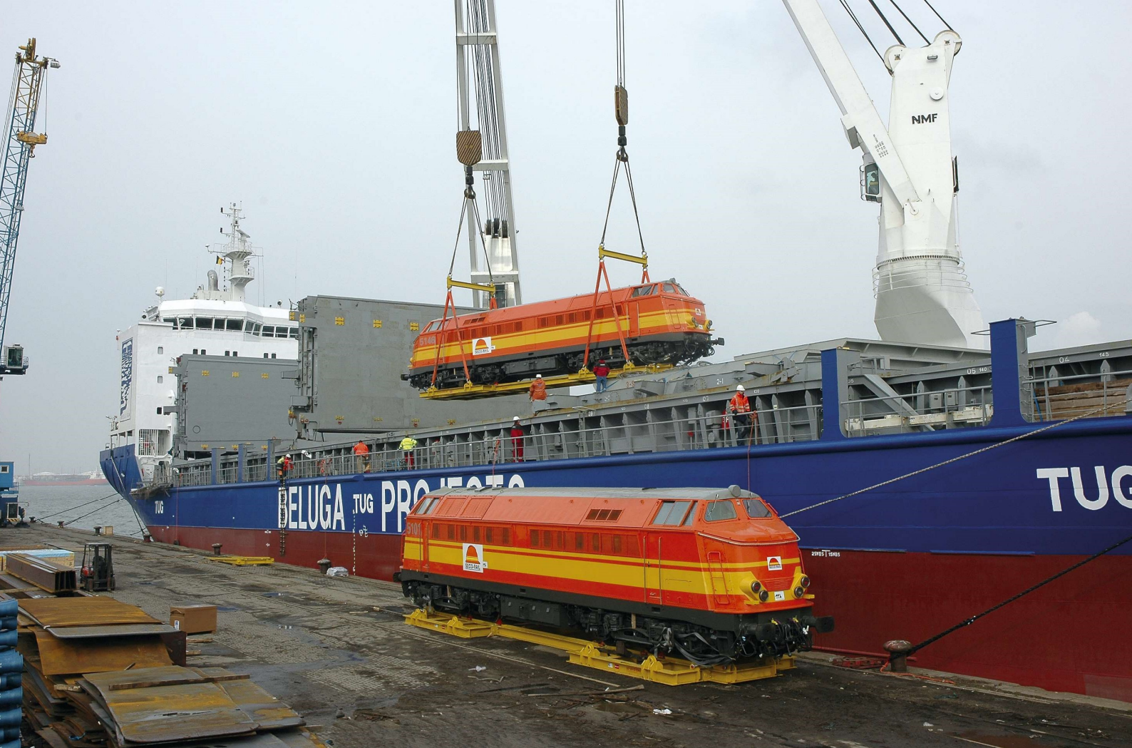
FOTOTHEMA 85 Absolute stilte tijdens een delicaat manoeuvre: de 5146 bengelt in de lucht hangend aan de kabels van de kranen van het vrachtschip. De 5101 wacht haar beurt af. Dave HABRAKEN.
