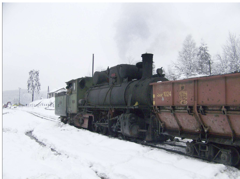
De grandioze 83-159 (D1, spoorbreedte 760 mm) duwt in Oskova de zelflossende wagenjes één voor één op. Dit exemplaar is het laatste van haar reeks dat nog in commerciële dienst wordt gebruikt. Ze werd gebouwd door Duro Dakovic in 1948. Thomas VAN WETTEREN.
