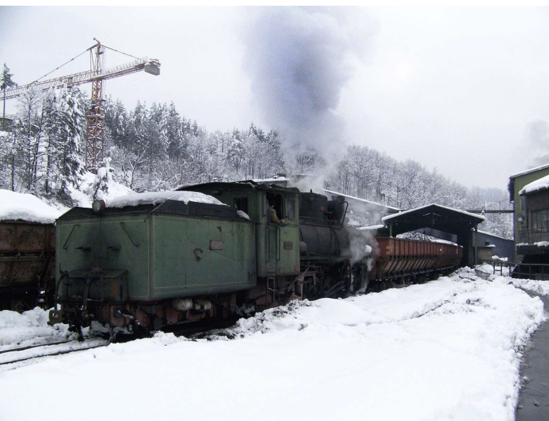
De grandioze 83-159 (D1, spoorbreedte 760 mm) duwt in Oskova de zelflossende wagenjes één voor één op. Dit exemplaar is het laatste van haar reeks dat nog in commerciële dienst wordt gebruikt. Ze werd gebouwd door Duro Dakovic in 1948. Thomas VAN WETTEREN.
