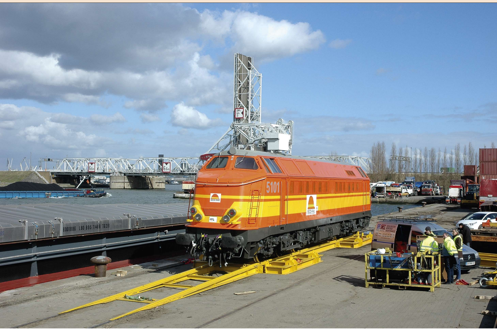
FOTOTHEMA 85 De twee locomotieven reden op eigen kracht op de spreader of laadwieg.
