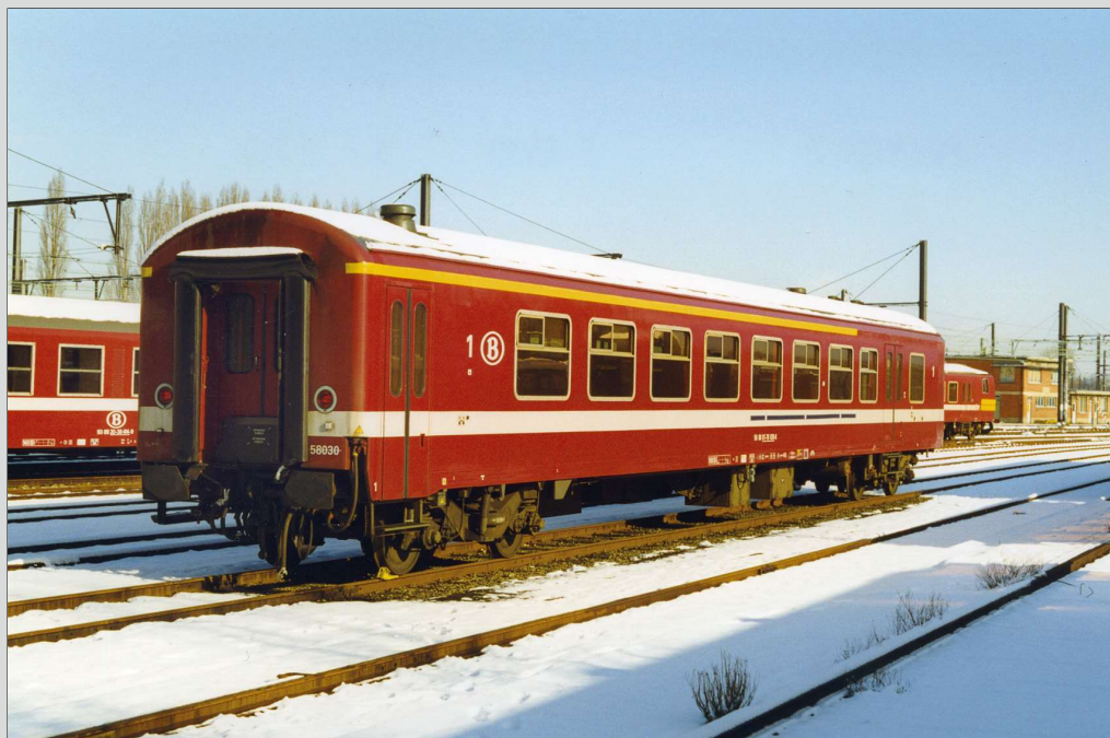
↓ FOTO 85-27 Rijtuig A58.030 in de bordeauxrode livrei. De blauwe lijn in het midden van de witte band, die de rokersplaatsen aanduidt, was oorspronkelijk niet aanwezig. Werkplaats van Schaarbeek, 4 februari 1999. Pierre HERBIET.
