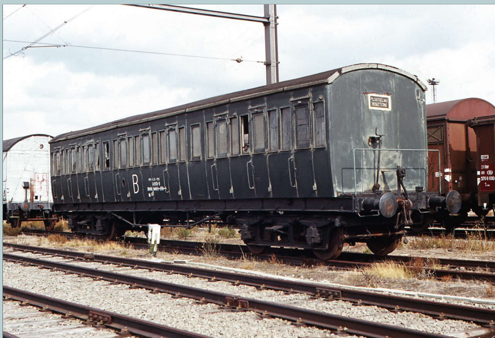
Na schrapping op 13 april 1960 werd dit rijtuig gebruikt als onderhoudspost voor rijtuigen in Brussel-Leopoldswijk. In afwachting van de verschroting stond het uitgeweken in de wagenwerkplaats van Schaarbeek. Het remmershuis en de treeplanken zijn reeds verwijderd. Jean-Luc VANDERHAEGEN, 19 september 1981.
