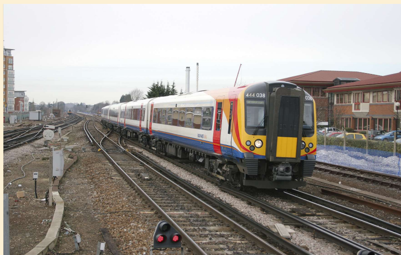
FOTO 85-24 De Desiro UK heeft een totaal ander uitzicht en is speciaal voor Groot-Brittannië ontworpen. Hier het vijf ledig elektrisch motorstel (750V via derde rail) 444 038 van South West Trains (45 motorstellen in dienst sedert 2004, inzet vanuit London Waterloo) bij aankomst te Basingstoke op 11 februari 2006. Philippe DE GIETER.
