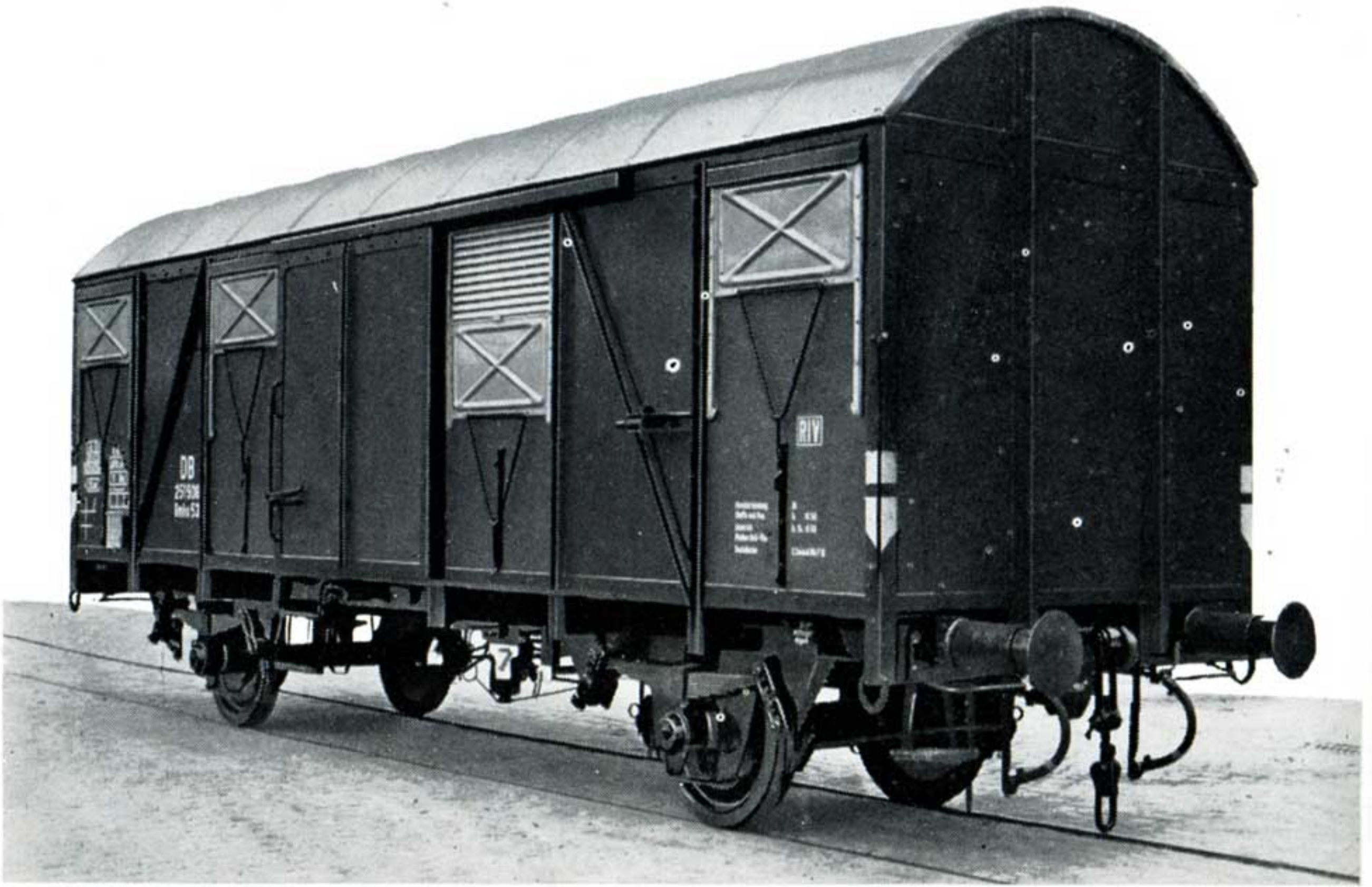
Bild 1: Wagen mit Tonnendach und 21 t Lastgrenze = Gmhs-Wagen
