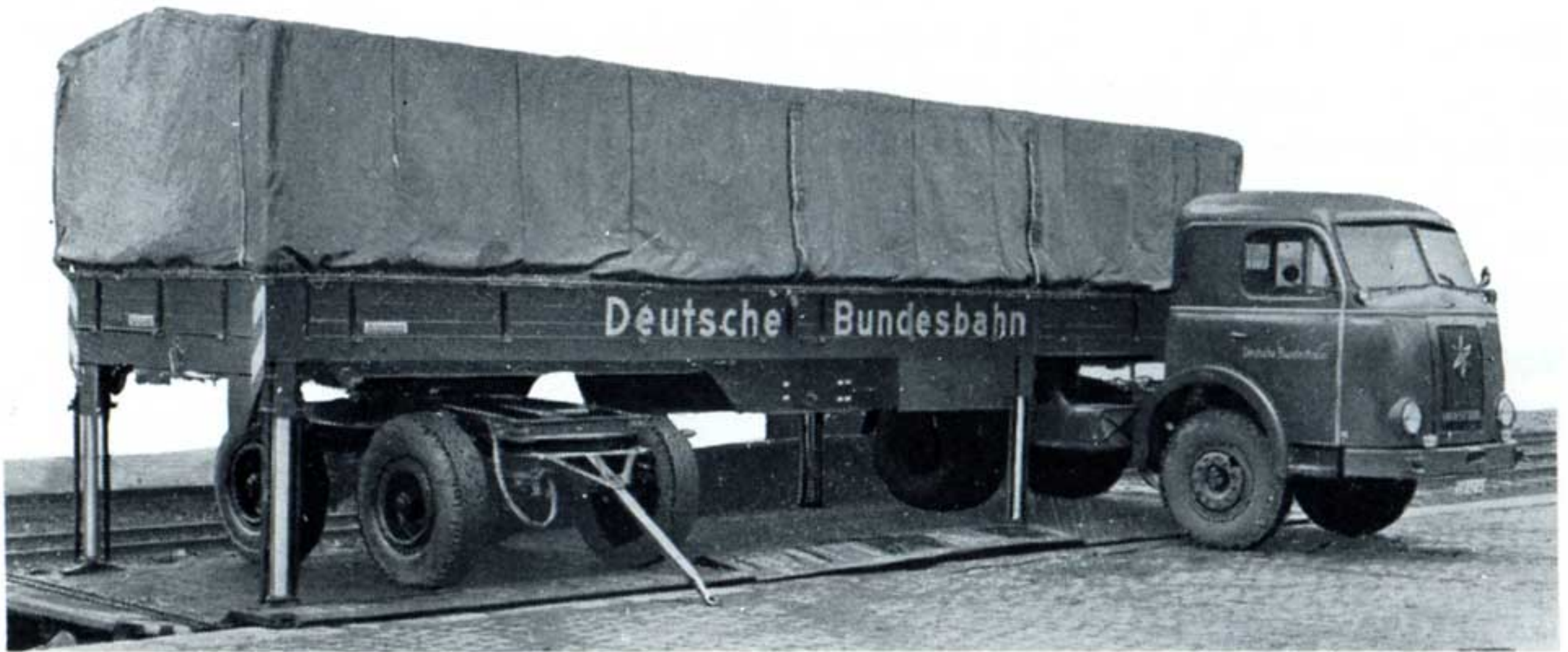
Bild 34: Sattelanhänger — Ausführungsform 2 — Verladung auf R-Wagen über Seitenrampe
