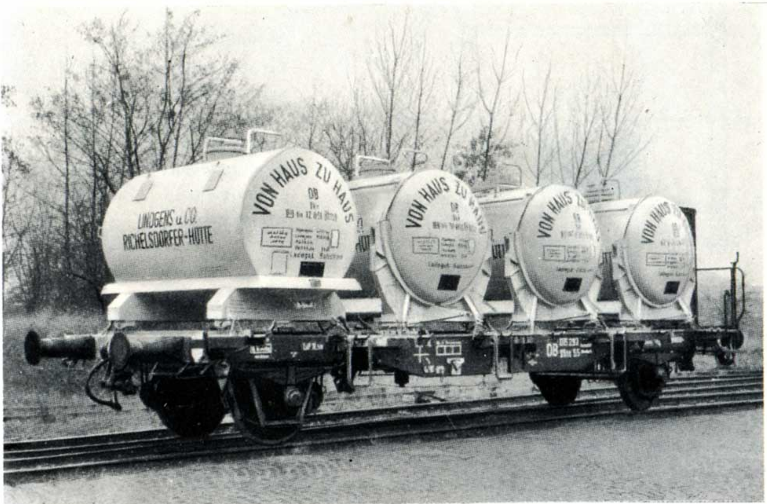
Bild 30: Behälter für Säuren und Laugen
