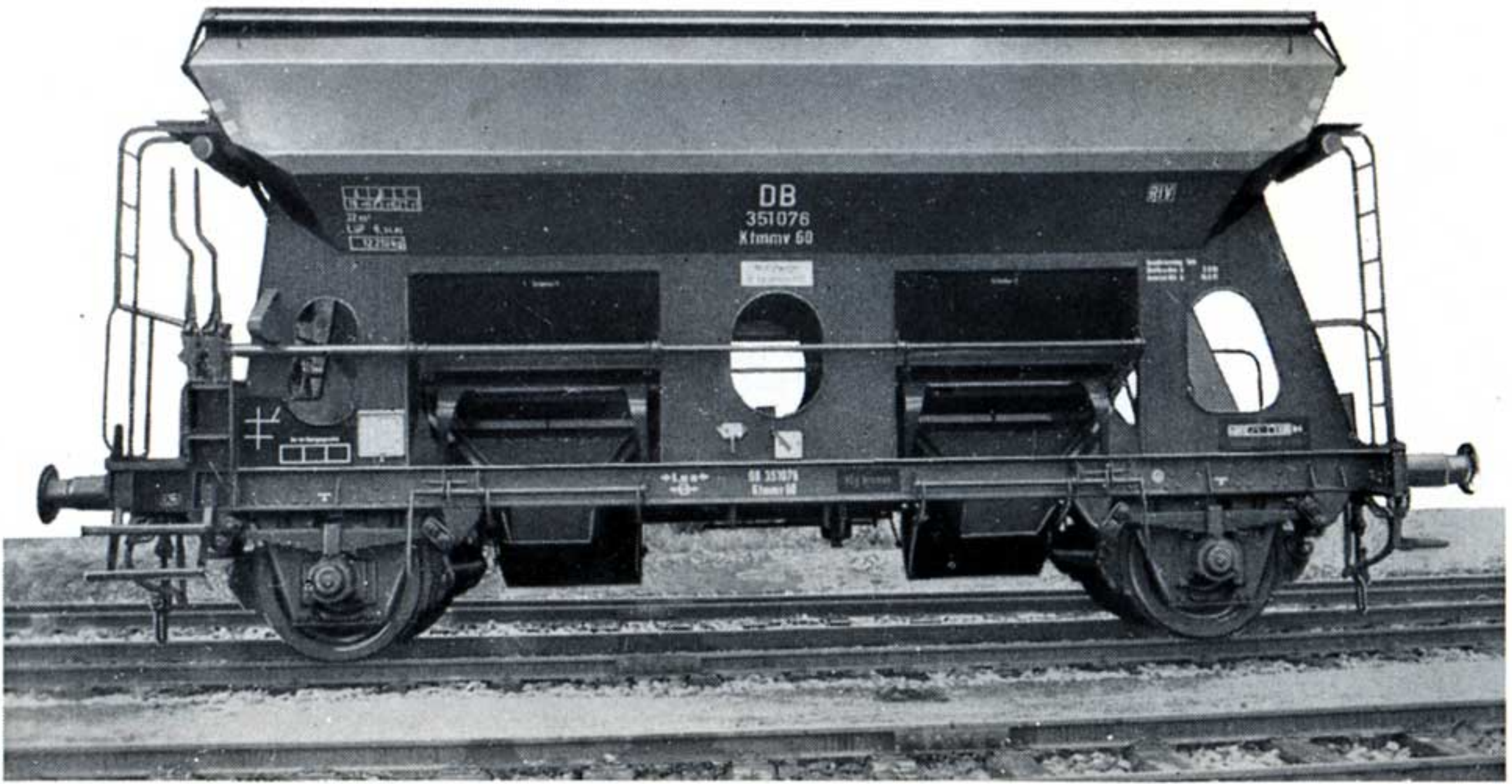
Bild 7: Selbstentladewagen mit Schwenkdach = Ktmv-Wagen
