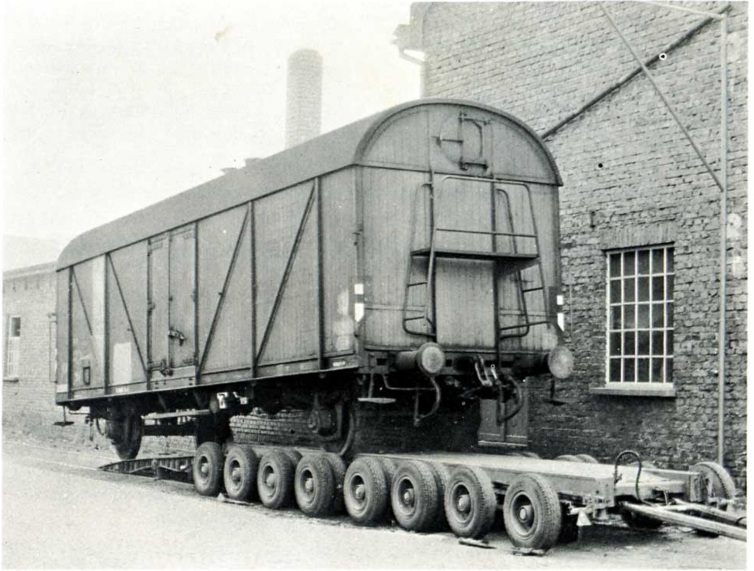
Bild 32: Güterwagen wird auf den Straßenroller gezogen
