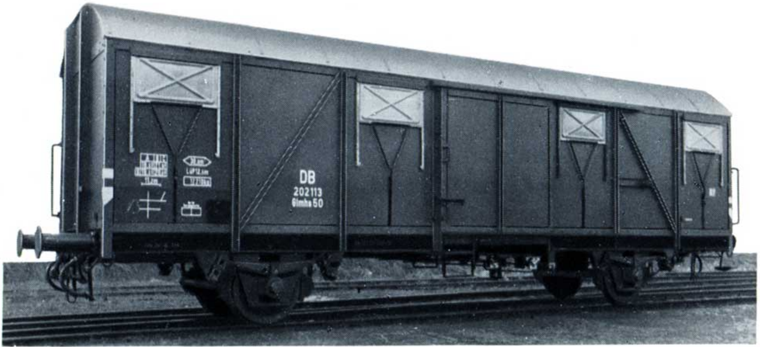
Bild 3: Großräumiger Wagen mit Tonnendach und 21 t Lastgrenze = Gmhs-Wagen
