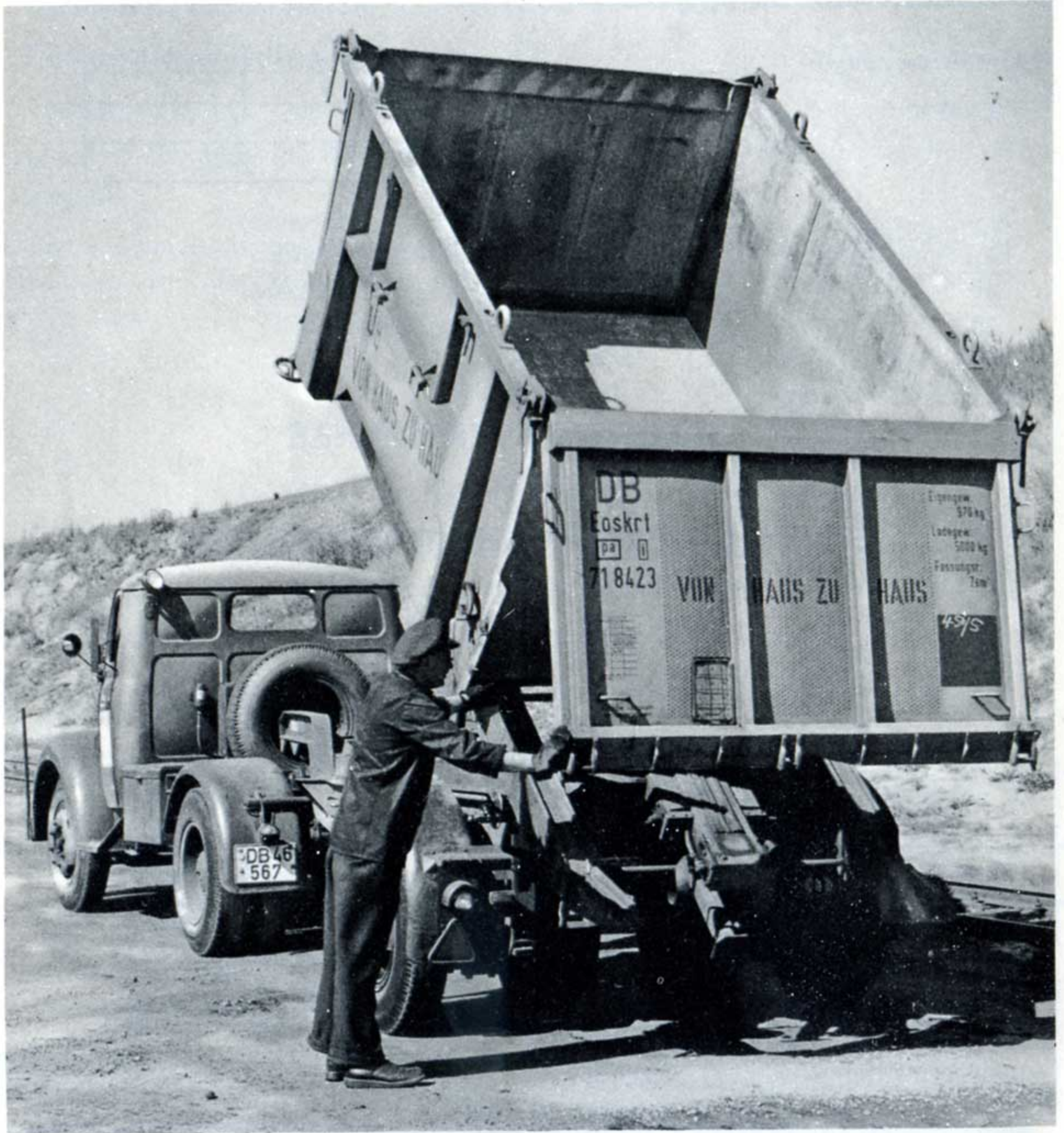
Bild 28: Zustellfahrzeuge in vereinfachter Ausführung
