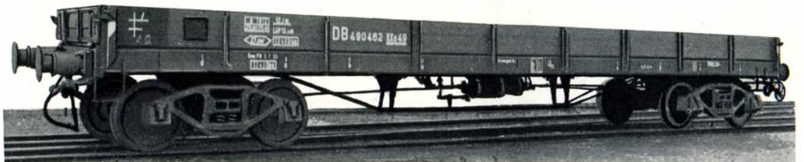
Bild 23: Wagen mit niedrigen Wänden = XXo-Wagen
