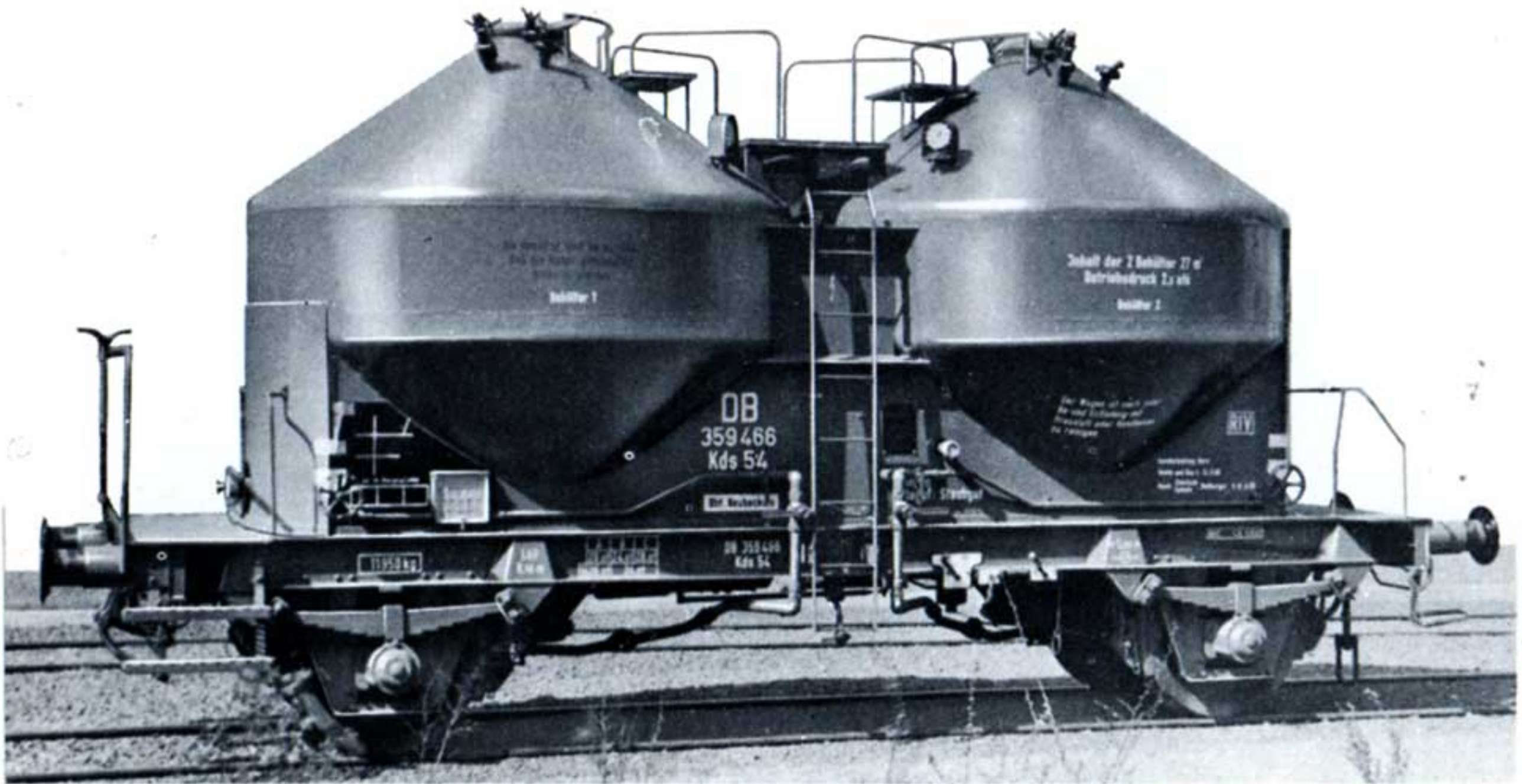
Bild 8: Wagen für staubförmige Güter mit Einrichtung
