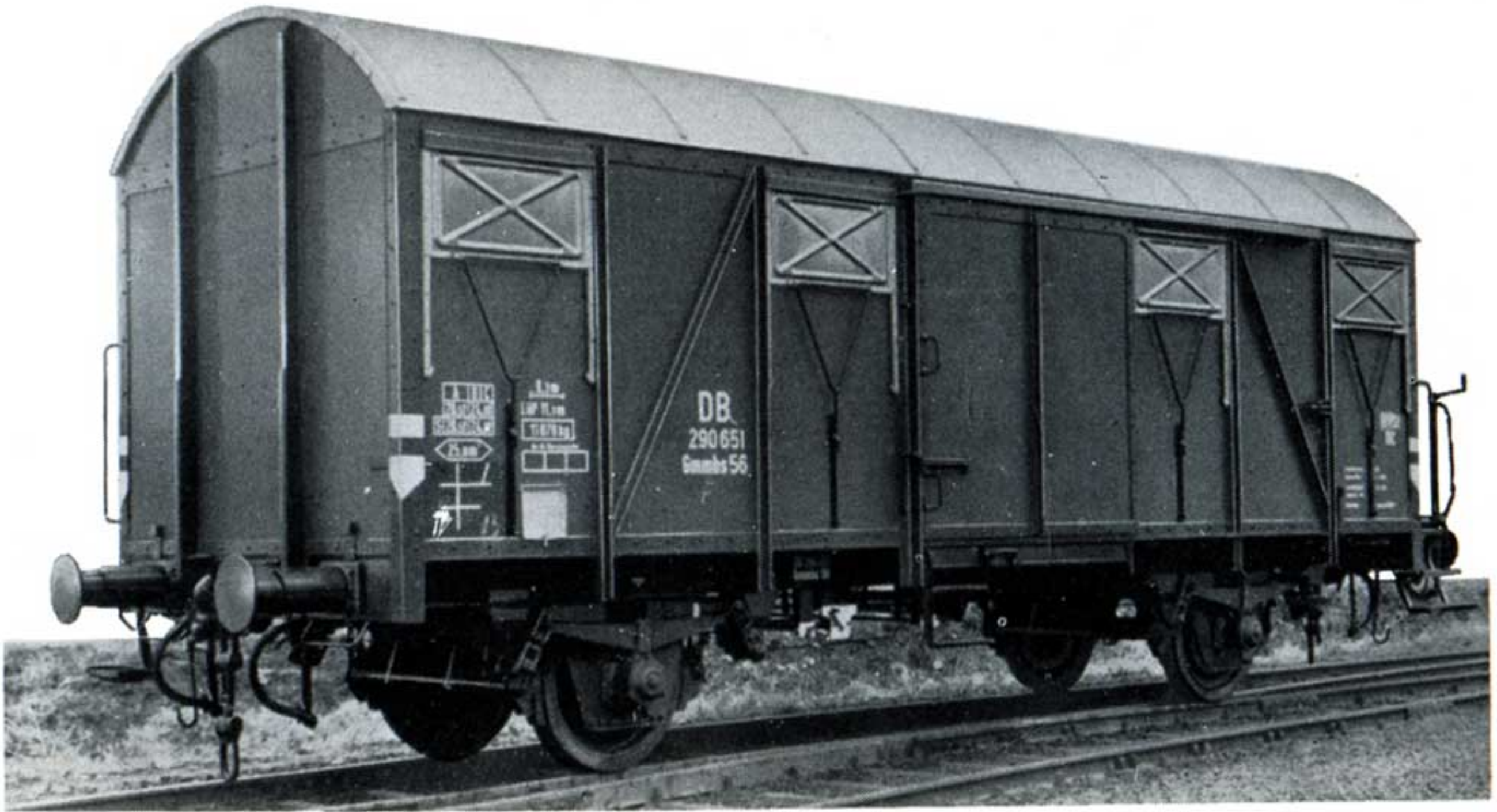
Bild 2: Wagen mit Tonnendach und 24 t Lastgrenze = Gmms-Wagen
