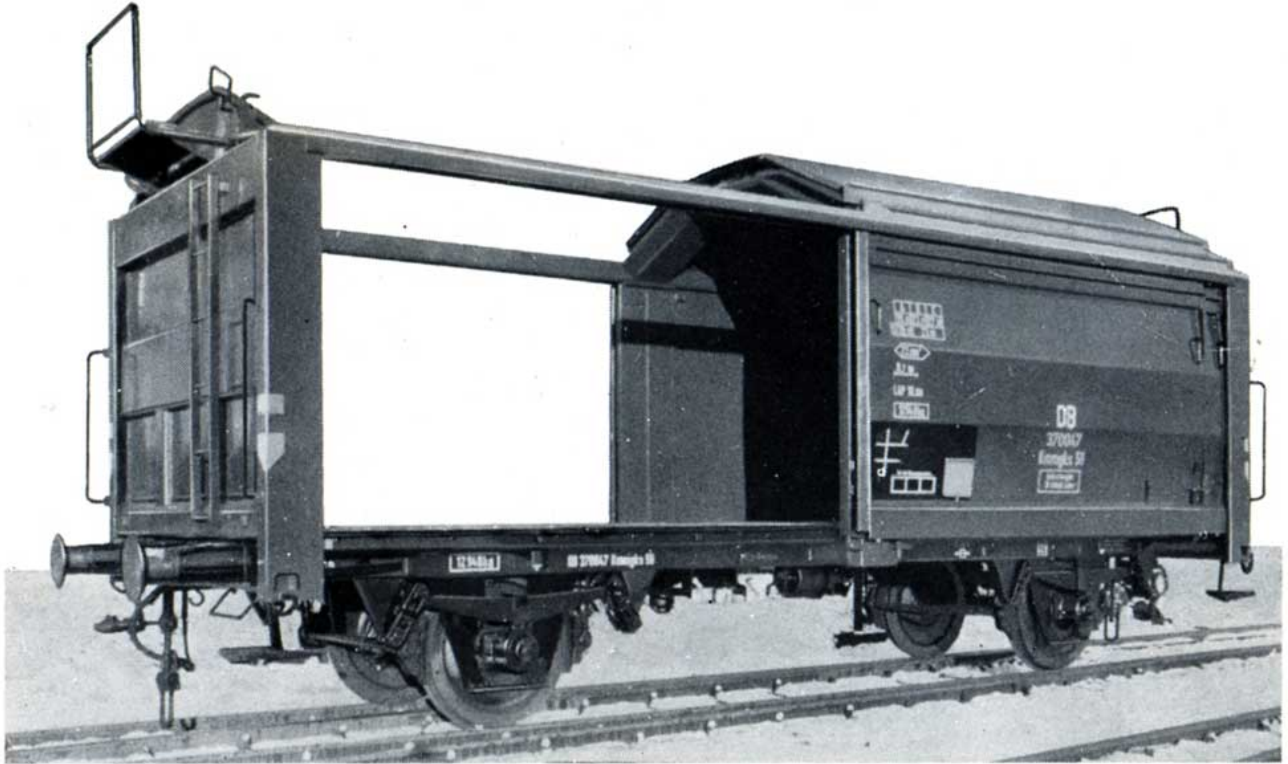
Bild 6: Wagen mit Schiebedach und Schiebewänden = Kmmgks-Wagen
