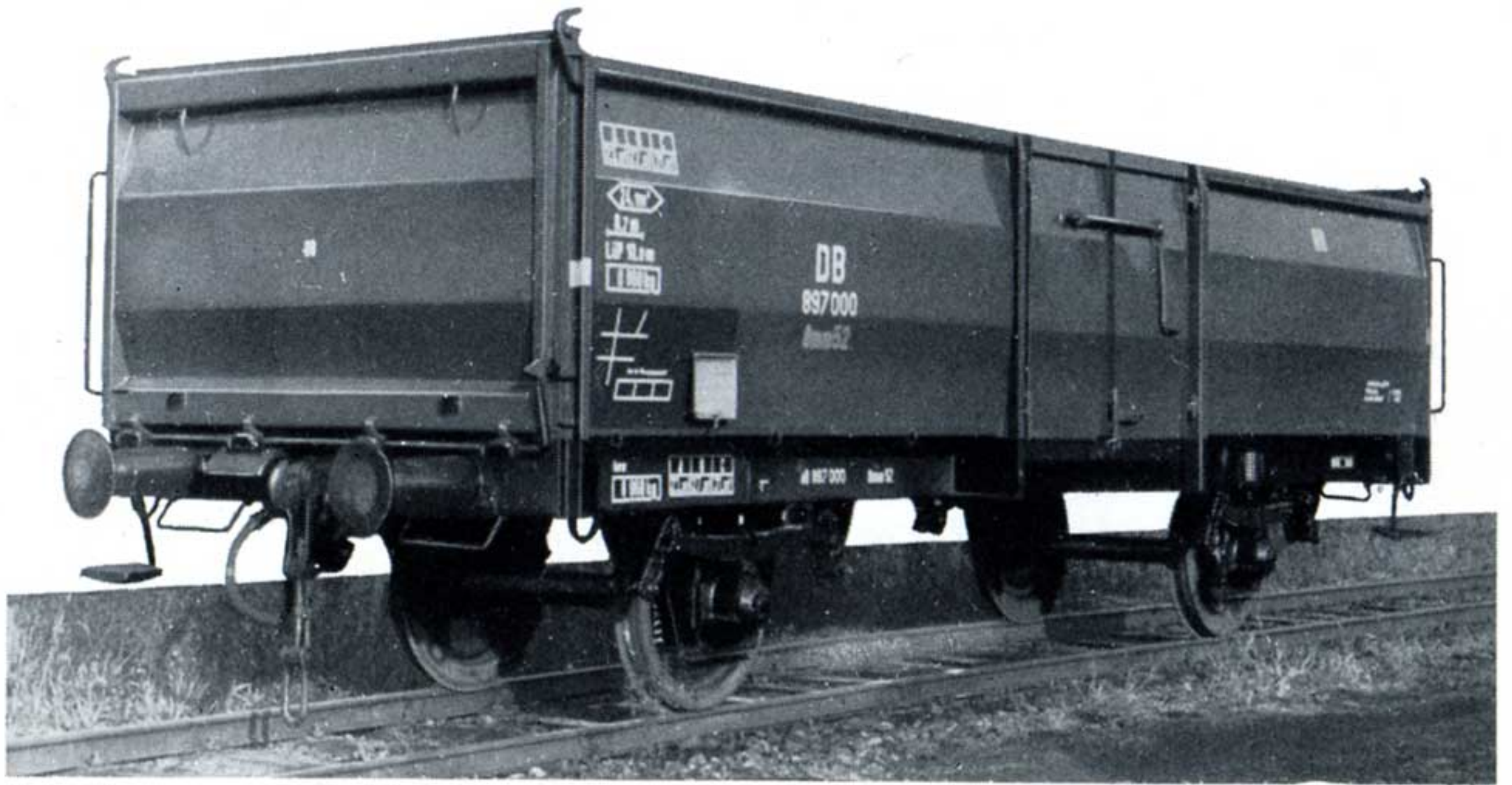
Bild 12: Offener Wagen der Regelbauart = Omm-Wagen
