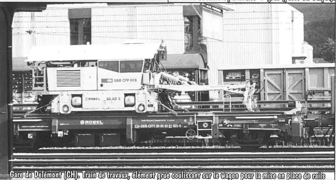
Gare de Delémont (CH). Train de travaux, élément grue coulissant sur le wagon pour la mise en place de rails
