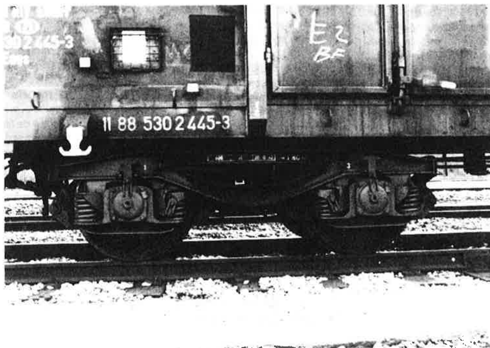
Eaos, détail du bogie Y25 soudé.
