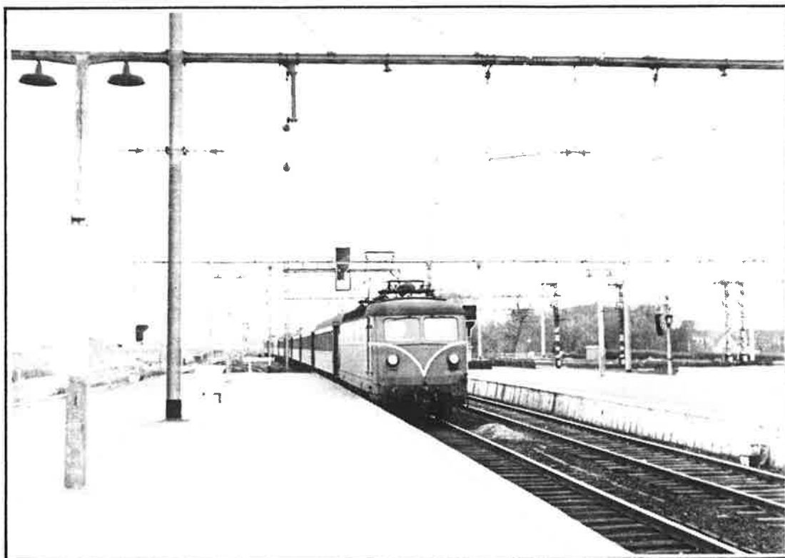
Locomotive 122.006 (future 2206) en gare de Brugge, le 30 / 12 / 1956. Remarquons au passage l'ancien montage de la caténaire sur transversaux, et le voisinage de deux époques de la signalisation.
