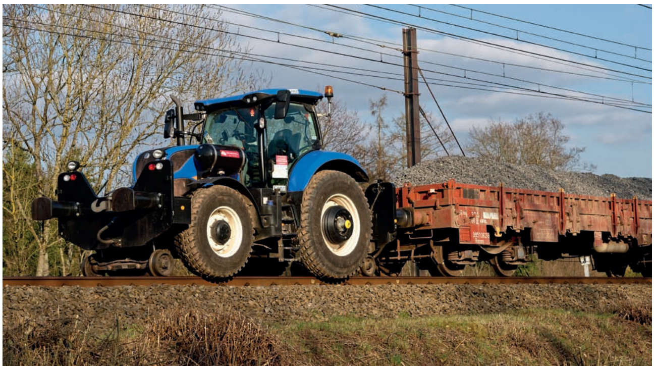
Travaux d'élargissement de la tranchée près de Forrières: locotracteur ral/route (construit par CML) en action sur ce chantier.
