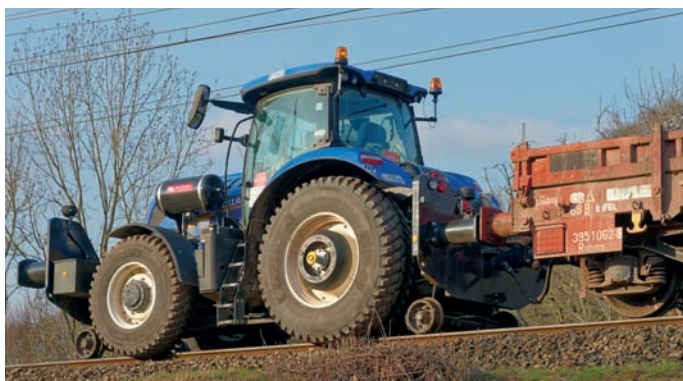
Travaux d'élargissement de la tranchée près de Forrières: locotracteur ral/route (construit par CML) en action sur ce chantier.
