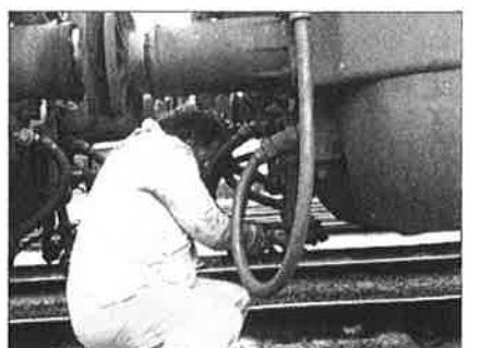
Manipulations aux conduites et purge des freins de la motrice électrique 2379 de la remise d'Oostende.
