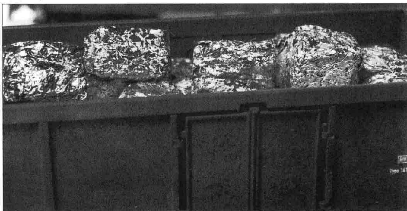
Détail du chargement du wagon : des balles de métaux comprimés.
