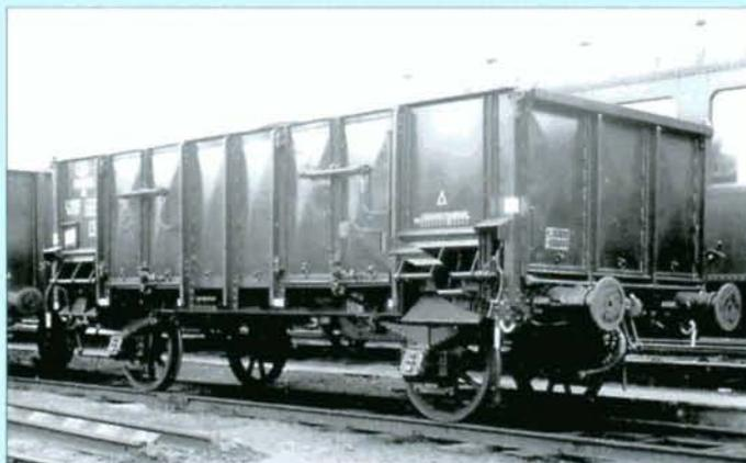
Un des wagons SNCF repris par la SNCB. Celui-ci, inventorié dans le type 1212H, porte le n° 1.060.106. Ce véhicule a servi comme wagon d'essai pour le déchargement à l'aide de clapets, visibles au-dessus de chaque roue. Photo SNCB.
