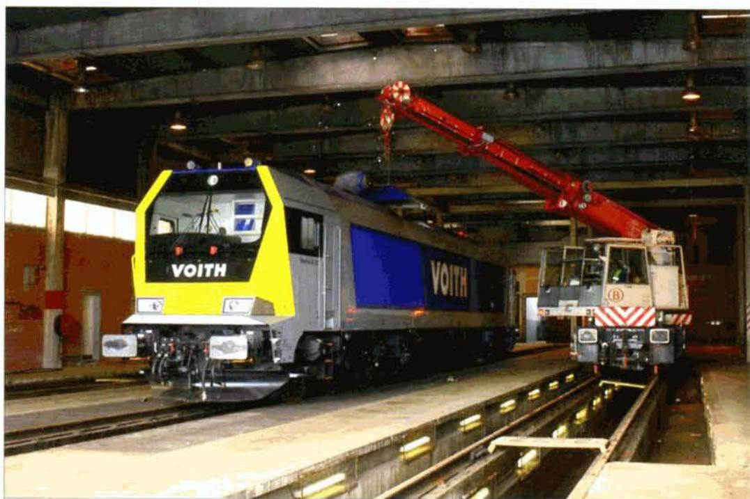
**PHOTO 96-55** Au milieu du mois de janvier, le moteur Diesel de la Maxima 40CC 592 80 12 64013-4 D - VTLT) utilisée par Crossrail a subi une avarie très grave. La machine a été garée dans l'ancienne remise de Montzen. Le 16 janvier, une grue de la SNCB fut utilisée pour retirer la toiture afin d'accéder au moteur. Elle est ressortie de réparation le 21 janvier. Michel HANSSSENS.
