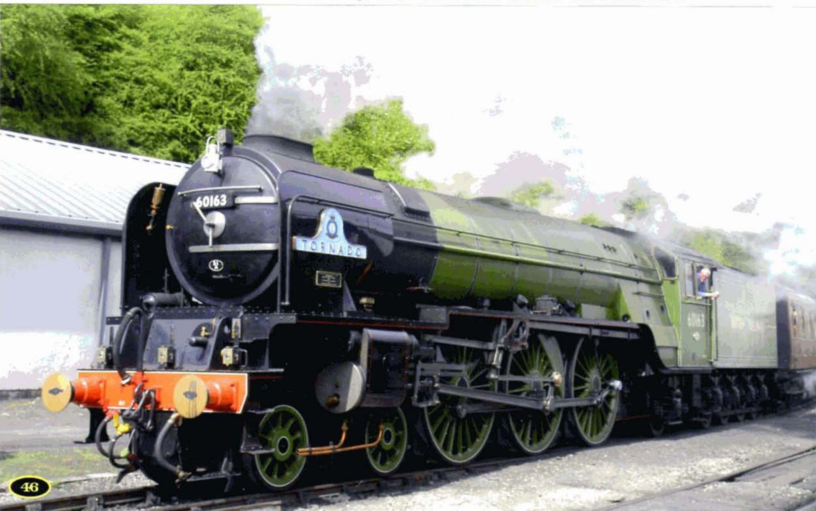
et du système électrique; diminution du poids de la machine; adjonction de freins à air pour le système de freinage principal et d'un éjecteur à vide pour que la locomotive puisse tracter des voitures sur les différents réseaux préservés.
