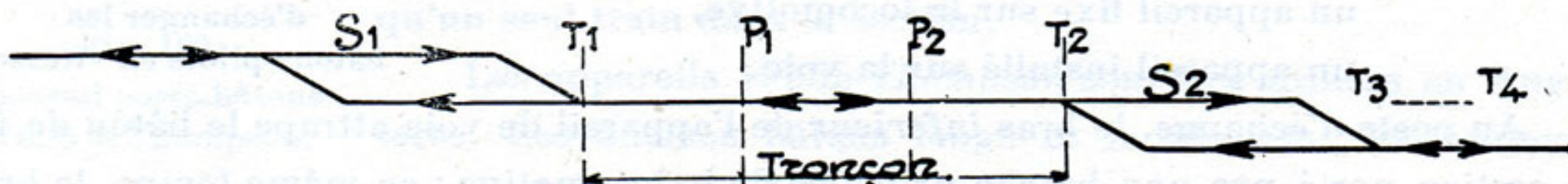
Fig. 172. — Block-system sur une ligne à voie unique.
