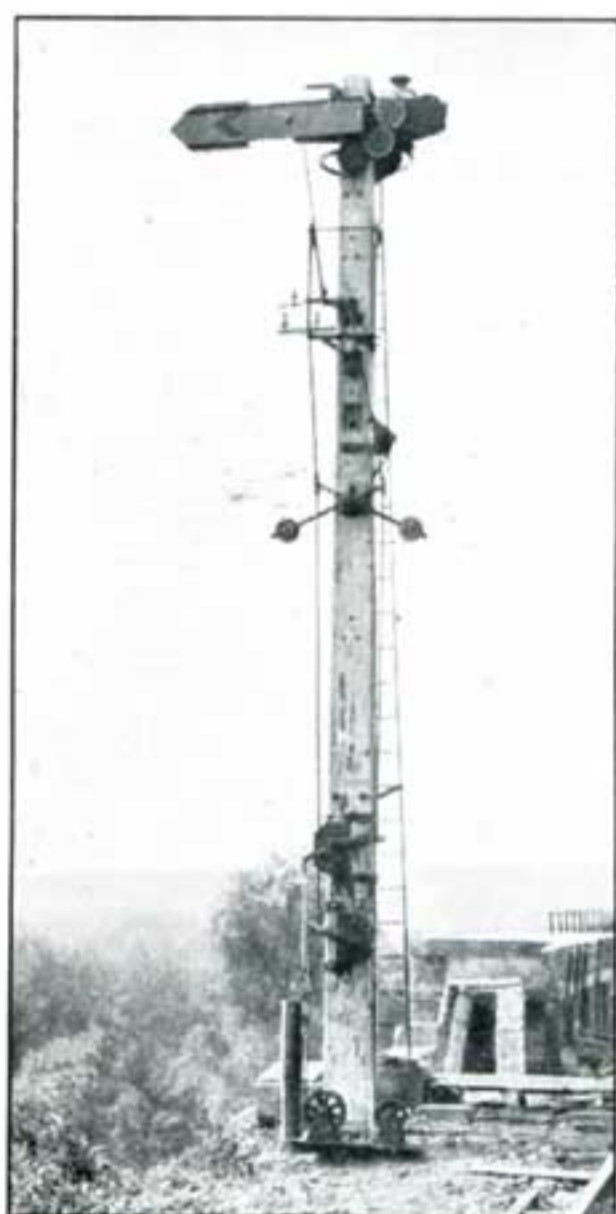
Sémaphore aversisseur muni de deux désengageurs.
