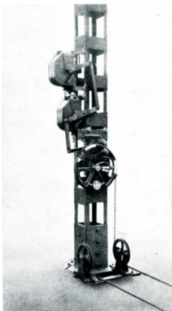
Poulie à came pour la manœuvre de palette de sémaphore montée avec 2 désengageurs.
