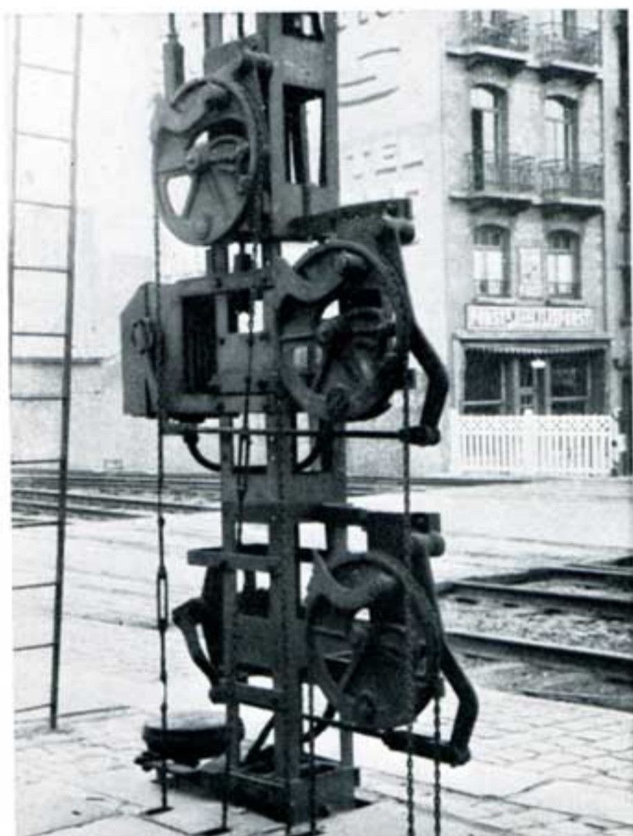
Poulies à came pour un sémaphore à trois palettes.
