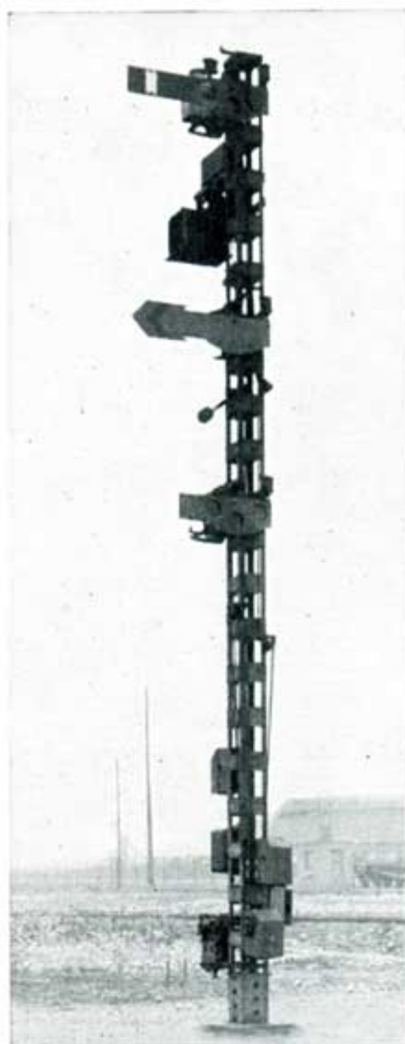
Sémaphore à trois palettes dont deux à trois positions, muni de moteurs et de trois boîtes d'accouplements.
